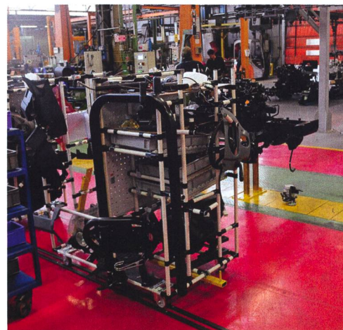
C'est avec ce genre de chariots que les composants sont transportés vers les chaînes de montage.
