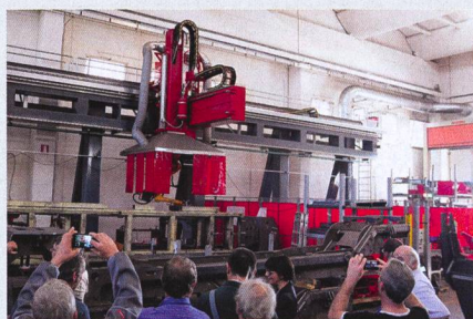
Nous avons été épatés par ce robot-soudeur assemblant un châssis de chargeur télescopique.
