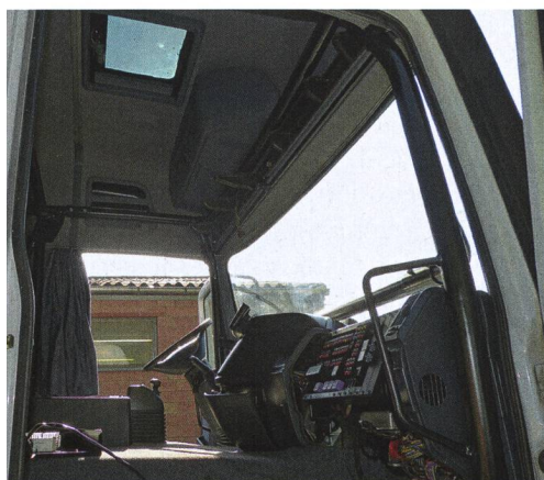
Pour qu'un camion puisse être immatriculé en tant que tracteur, Willi Signer fabrique des cadres de protection sur mesure et les intègre dans la cabine.
