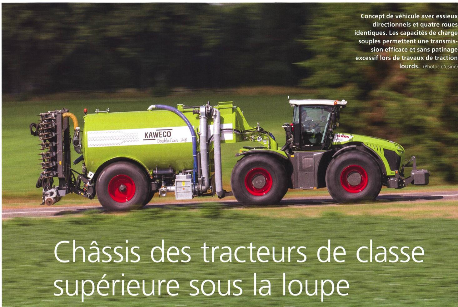
Concept de véhicule avec essieux directionnels et quatre roues identiques. Les capacités de charge souples permettent une transmission efficace et sans patinage excessif lors de travaux de traction lourds. (Photos d'usine)
