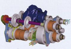
La nouvelle transmission CNH pour les gros tracteurs Case IH Magnum et New Holland T8. Quatre embrayages multidisques permettent de commuter les quatre plages de vitesses (en orange, en bas à g.), deux autres (en orange, à droite dans l'image) servent pour l'inverseur.
