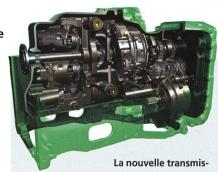
sion IVT que John Deere prévoit pour sa série 7R. On distingue l'unité hydrostatique à double étrier (à g.) et le double train épicycloïdal, au centre de l'image.
