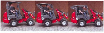
Easy Protection System Plus de Weidemann: Le toit abaissable hydrauliquement en hauteur permet d'améliorer considérablement la sécurité du travail de l'opérateur. Par la possibilité d'abaisser, il n'y a plus besoin comme fort souvent en pratique de démonter
