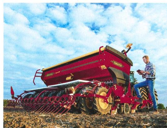
culteur de modifier en continu la quantité de semences par hectare, une nouvelle forme de trémie, légèrement tirée vers l'avant pour améliorer l'accès à la machine ; et une nouvelle herse à l'arrière, disponible en modèles mécanique ou hydraulique.
