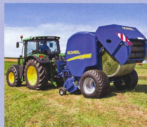
ment automatique. La G-1 est équipée d'un liage à filet et à film. Le temps de liage d'une balle est divisé par deux grâce au double liage, une première mondiale !
