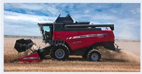
La moissonneuse-batteuse Activa S 7345 à cinq secoueurs est maintenant équipée d'un moteur Agco Power d'une puissance de 243 ch.
