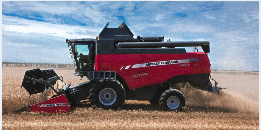
La moissonneuse-batteuse Activa S 7345 à cinq secoueurs est maintenant équipée d'un moteur Agco Power d'une puissance de 243 ch.
