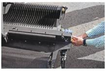
Claas est l'unique constructeur à offrir un intervalle entre couteaux de seulement 20 mm sur son système Fine Cut. Conçu pour la paille, celui-ci permet des longueurs de coupe particulièrement réduites.
