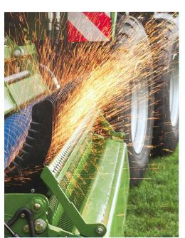
Les rotors des autochargeuses offrent une large surface de transport, jusqu'à 75 % de la largeur du rotor servant à propulser le fourrage.
