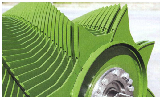
Sur les autochargeuses de Krone et de Strautmann (à droite), les dents du rotor sont recouvertes de plaquettes en acier hardox, résistantes à l'usure. Chez Strautmann, les pointes sont en outre renforcées par une couche durcie supplémentaire. (Photos: Idd)
