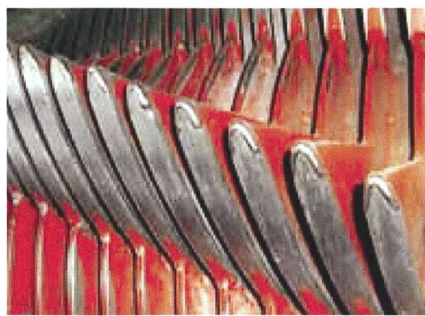
Sur les autochargeuses de Krone et de Strautmann (à droite), les dents du rotor sont recouvertes de plaquettes en acier hardox, résistantes à l'usure. Chez Strautmann, les pointes sont en outre renforcées par une couche durcie supplémentaire. (Photos: Idd)
