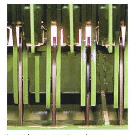
Lorsque les couteaux sont espacés, l'effet de cisaillage ne peut être obtenu qu'en dédoublant les dents.
