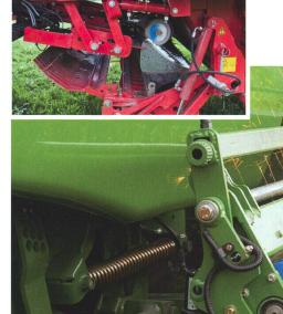
L'automate affûteur Speed Sharp de Krone permet d'aiguiser simultanément 23 couteaux après avoir basculé la barre porte-couteaux vers l'extérieu<u>r</u>.
