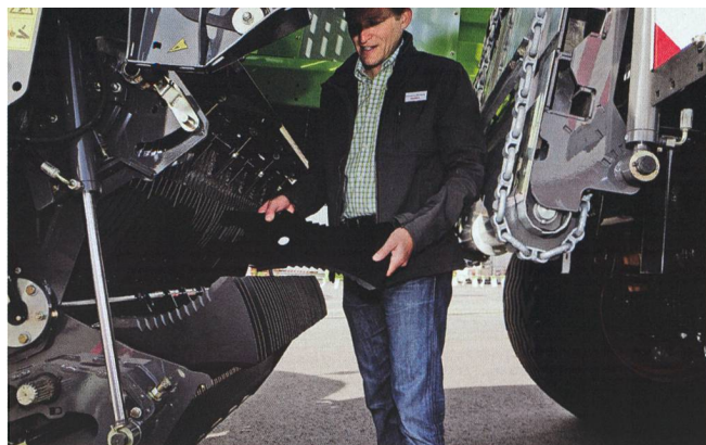
Sur la nouvelle Cargos de Claas, l'accès aux couteaux bi-lames d'un nouveau type se fait simplement en pivotant le fond mouvant vers le bas.
