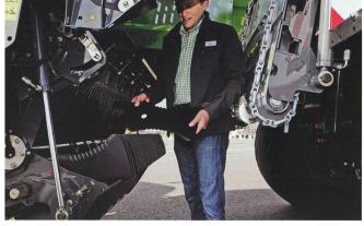
Sur la nouvelle Cargos de Claas, l'accès aux couteaux bi-lames d'un nouveau type se fait simplement en pivotant le fond mouvant vers le bas.
