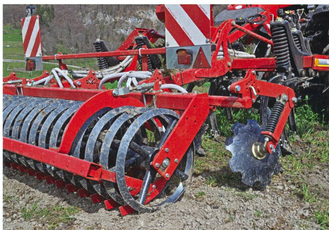
Les disques de nivellement indépendant et le rouleau packer RollCut laissent une surface plate et prête au semis.
