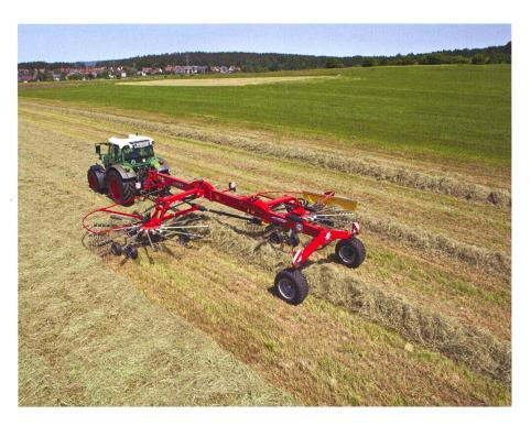
cendre pour modifier le dépôt des andains. En outre, dans le modèle PRO du TS 7850, les toupies pour le dispositif de sécurité de transport sont bloquées par le bloc de verrouillage hydraulique. La hauteur de travail des toupies de cette machine se règle désormais hydrauliquement. Tandis que la commande du TS 7850 se fait par le système hydraulique du tracteur, le nouveau TS 7850 PRO est équipé en série d'une commande électro-hydraulique via le boîtier de commande FELLA.
