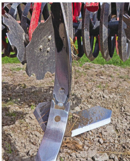
Le soc MulchMix est constitué d'une pointe, d'un déflecteur qui peut être changé de côté en pivotant et de deux ailettes de part et d'autre.
