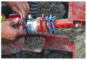
Les clips alu se trouvent sous un couvercle et servent indirectement à régler la profondeur de travail.
