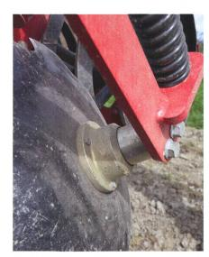
Les disques ne nécessitent pas d'entretien grâce à un graissage préalable permanent.
