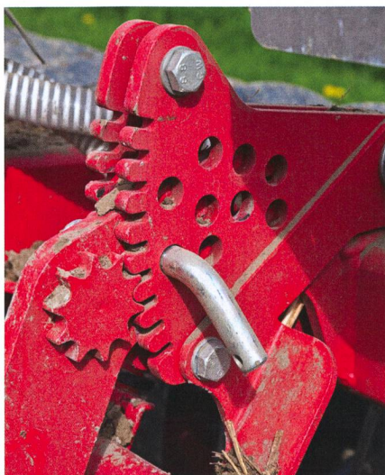
Les disques de nivellement se règlent par rotation des engrenages et sont assurés par un boulon. Pour cela, une clavette est nécessaire. Photos: Ruedi Hunger.
