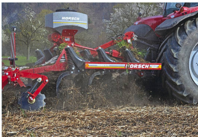
L'espace assez grand entre le bâti du cultivateur et le sol permet à la terre de s'écouler librement. (Photos: Ruedi Hunger)
