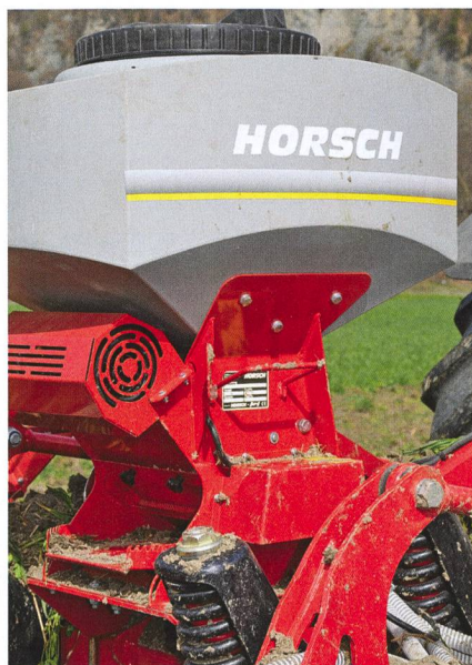
Horsch équipe sur demande le Terrano d'un dispositif de semis APV, une option qui peut être utile lors du déchaumage.
