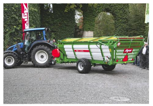
Les largeurs de châssis ont été définies dans l'objectif de ne pas dépasser, même avec des pneus larges (19.0/45-17), une largeur extérieure maximale de 2,55 m. (Photos: Ueli Zweifel)
