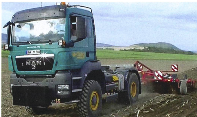
Les vrais « Agro-Trucks » possèdent prise de force, circuit hydraulique et relevage ; en cas de besoin et si les conditions le permettent, ils peuvent servir à d'autres tâches que des simples transports.
