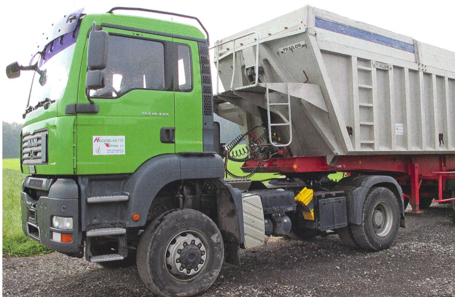
Le tracteur à sellette de Willi Wittwer est doté d'une transmission intégrale mécanique avec réducteur. (Photo : Willi Wittwer)
