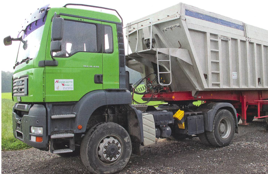
Le tracteur à sellette de Willi Wittwer est doté d'une transmission intégrale mécanique avec réducteur. (Photo : Willi Wittwer)
