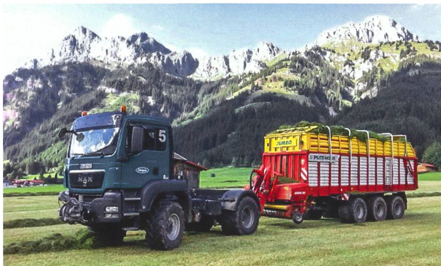
Cet attelage composé d'un « Agro-Trucks » et d'une autochargeuse à rotor pourrait aussi intéresser des séchoirs à herbe et des entreprises suisses. Mais on ne peut pas encore, en Suisse, immatriculer de camion avec des pneus de terrain ; sa largeur dépasserait les 2,55 m réglementaires. L'ASETA va se saisir de cette problématique et proposer des solutions.
