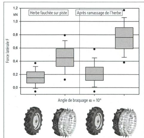
**Que la roue agricole soit utilisée seule ou associée à une roue à picots Rapid, la présence de la couche d'herbe fauchée a un impact négatif sur la transmission des efforts latéraux.**
