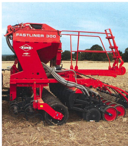
Sur les semoirs mécaniques, la trémie occupe à peu près la largeur de la machine.
