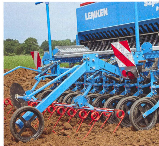
Une roue à impulsion mesure la vitesse d'avancement pour régler la distribution à moteur électrique.
