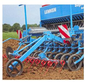
Une roue à impulsion mesure la vitesse d'avancement pour régler la distribution à moteur électrique.
