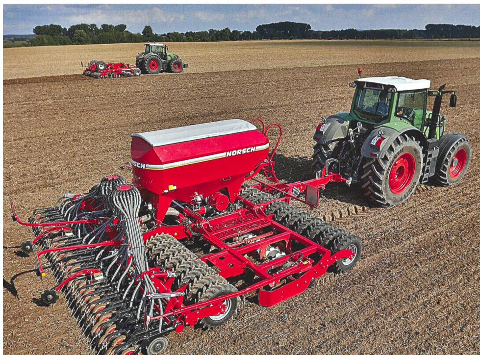
Grâce à sa technique de dosage innovante, le semoir Pronto de Horsch est capable de semer des céréales très précisément jusqu'à une vitesse de 12 km/h. (Photo d'usine)
