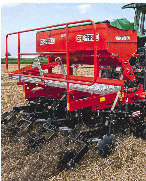
De robustes socs semeurs montés sous parallélogramme assurent au « Strip-Tiller Zebra » de Gaspardo une vitesse de travail élevée même avec de nombreux résidus végétaux et dans des conditions difficiles.
