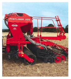
Sur les semoirs mécaniques, la trémie occupe à peu près la largeur de la machine.
