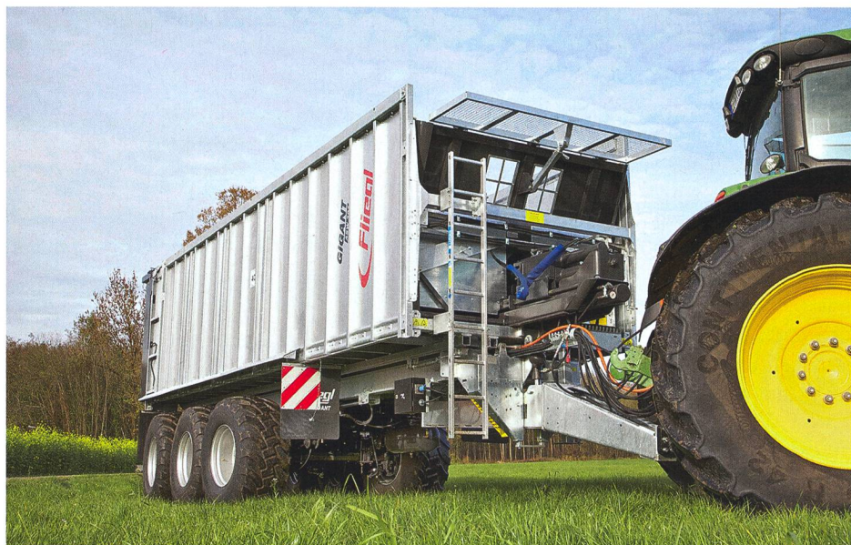
C'est dans des conditions de terrain difficiles que l'essieu moteur rend de grands services sous une remorque. (Photo d'usine)
