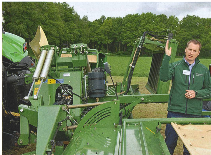
Matthias Sperver explique le fonctionnement et montre comment monter et mettre en route les convoyeurs latéraux de l'EasyCut.
