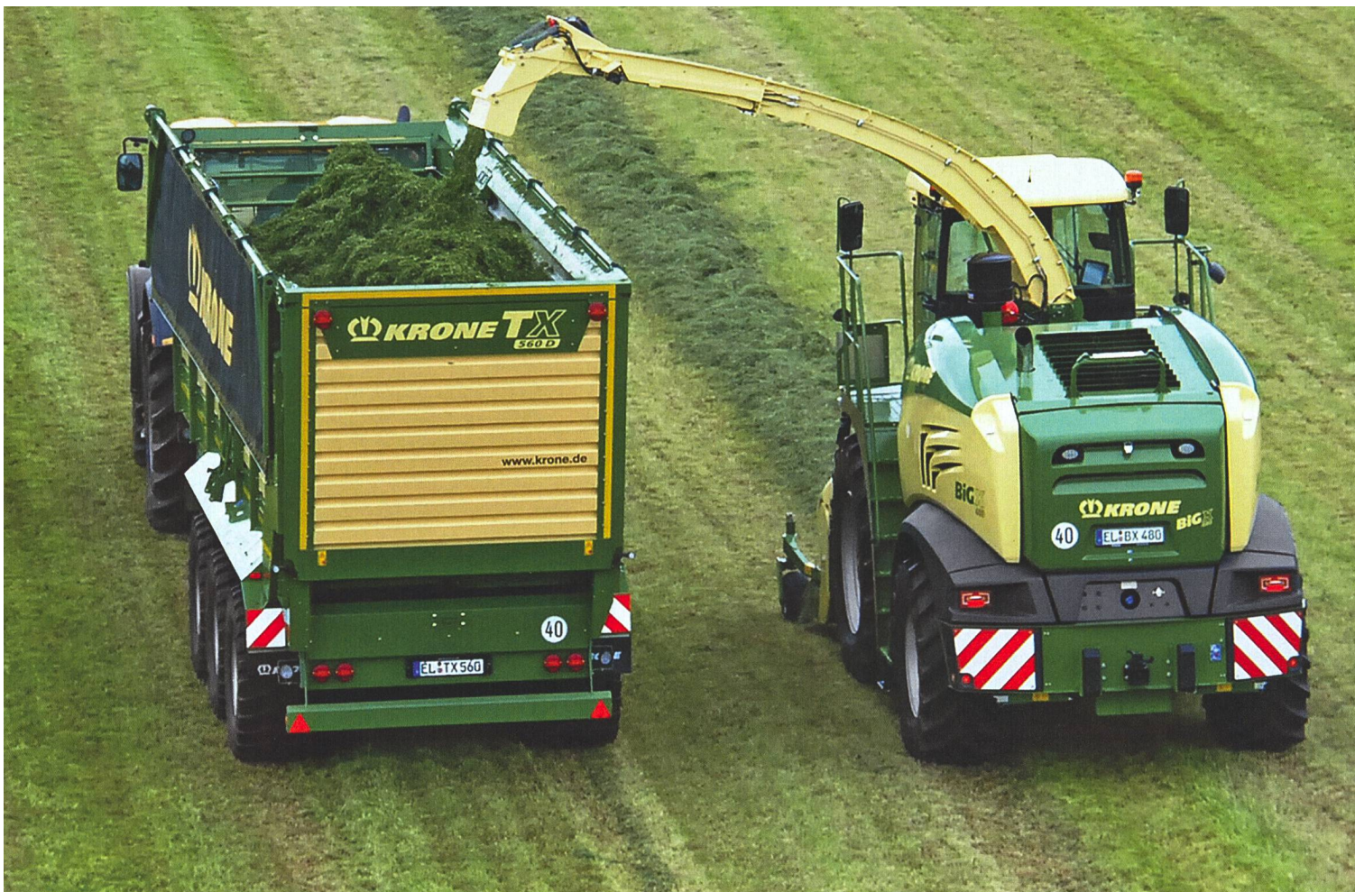
A Spelle, Krone a dévoilé en première mondiale l'ensileuse BiG X 480 (489 chevaux), suivie ici de la remorque pour ensilage TX 560 D, offrant un volume utile de 56 m 3 et équipée d'un doseur. (Photos: Dominik Senn)
