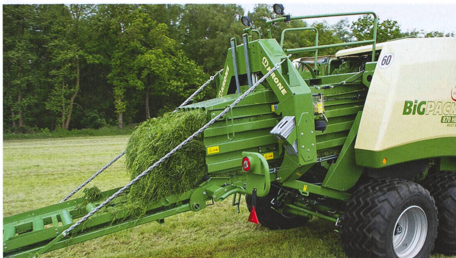
Le canal de la presse à grandes bottes parallélipédiques BiG Pack HDP XC MultiBale mesure 80 x 90 cm.
