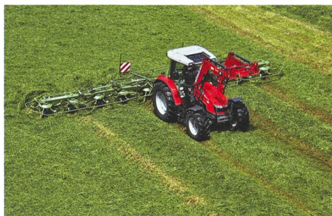
La nouvelle pirouette trainée au 3-points KW 11.22/10 à dix toupies à six bras chacune.
