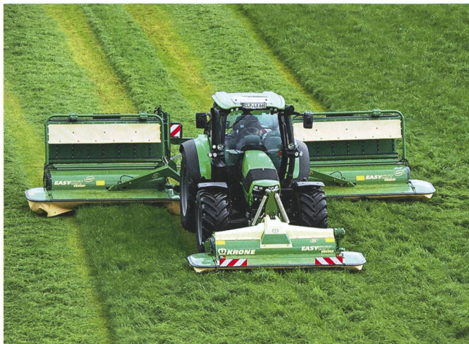
La nouvelle faucheuse-conditionneuse EasyCut B 870 CV Collect avec convoyeur latéral et faucheuse frontale F 320 CV. La conditionneuse est à dents en acier en V.
