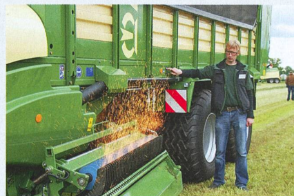
Le processus d'affûtage est en cours; 23 couteaux sont aiguisés simultanément par séquence.
