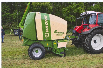
La presse à balles rondes Fortima F 1259 MC à chambre fixe produit des balles de 1,25 m de diamètre.
