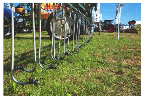
Les droplegs sont espacés sur la rampe en fonction de l'interrangs de la culture.
