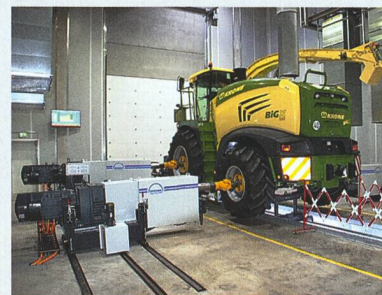
A Spelle, le nouveau banc d'essai de Krone mesure les performances d'une BiG X 580 sortant de l'usine.
