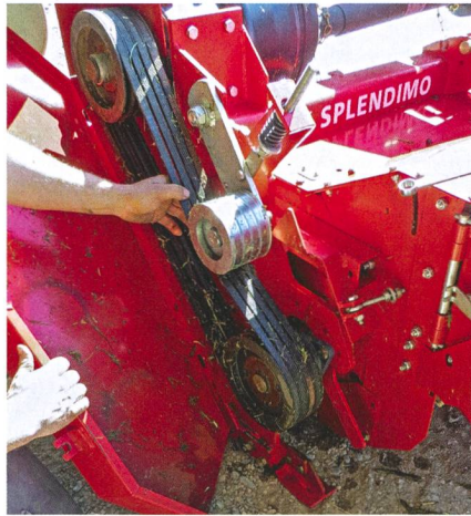
Le conditionneur est entraîné par quatre courroies trapézoïdales avec tendeur automatique.
