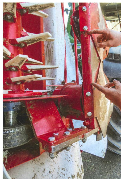
Un élément intermédiaire sert au maintien de la distance entre les diverses unités de fauche.
