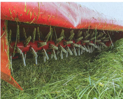
Le conditionneur Impeller de Lely détruit la couche cireuse des plantes sans les briser avec ses 132 doigts synthétiques.
