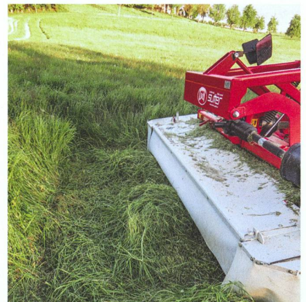
Visualisation de l'angle de coupe de l'herbe, presque droit grâce au grand chevauchement des couteaux.
