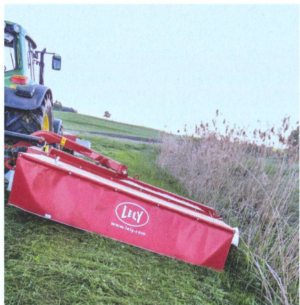
L'angle de 20° permet de travailler également dans les talus.
