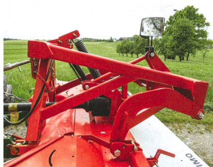
Fixation suspendue pour une bonne adaptation au sol. Le vérin de levage se trouve à droite du ressort. Le vérin hydraulique intégré au bras est couplé au moyen d'un raccord à l'hydraulique frontale et soutient le levage de la faucheuse.
