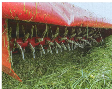
Le conditionneur Impeller de Lely détruit la couche cireuse des plantes sans les briser avec ses 132 doigts synthétiques.
