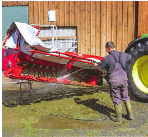
Les protections des deux faucheuses sont rapidement rabattables, d'où un entretien facilité.
