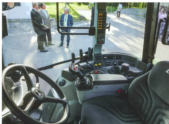
Les principales commandes des fonctions du tracteur sont accessibles sur le levier multifonctions placé sur l'accoudoir.
