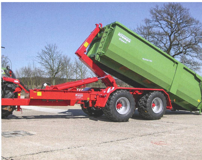
Les remorques avec bras à crochet trouvent toutes sortes d'utilisations et permettent d'engager des camions dans la chaîne logistique.
