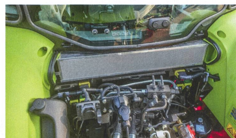
Le filtre à air de la cabine est placé derrière elle; l'aspiration se fait sur les garde-boue.
