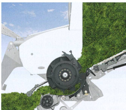
Grâce au fond mouvant inclinable des Cargos, le fourrage entre dans l'autochargeuse par le plus court chemin, ce qui réduit la consommation.
