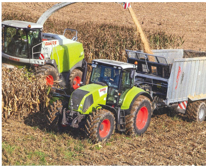
Très stables, les remorques à fond poussant sont particulièrement adaptées pour le remplissage de silos horizontaux.
