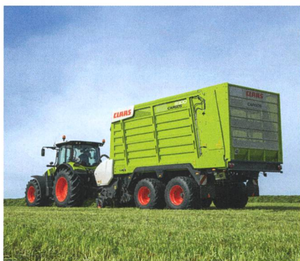
Les Cargos 8000 offrent entre 30 et 41 m 3 de volume. Le plus grand modèle est disponible avec essieu tandem ou tridem.
