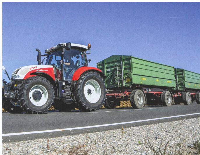
Le train routier classique avec deux remorques basculantes à deux essieux nécessite un véhicule tracteur suffisamment lourd.
