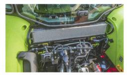
Le filtre à air de la cabine est placé derrière elle; l'aspiration se fait sur les garde-boue.
