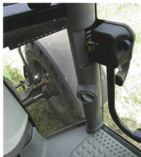
Les deux buses au-dessus du plancher permettent de se réchauffer les pieds.
