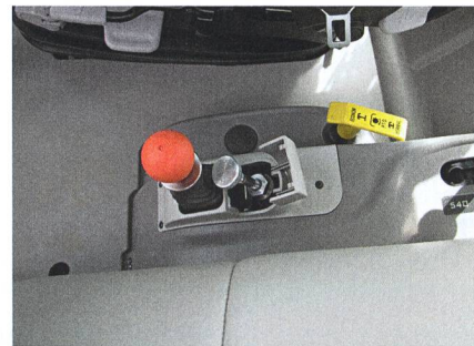
Ce levier actionne le nouveau frein de stationnement à ressort.
