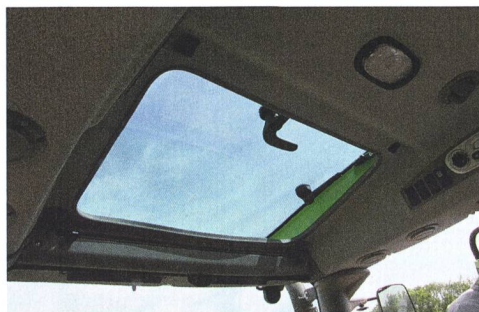
La fenêtre de toit permet de garder l'œil sur les outils frontaux en position haute.
