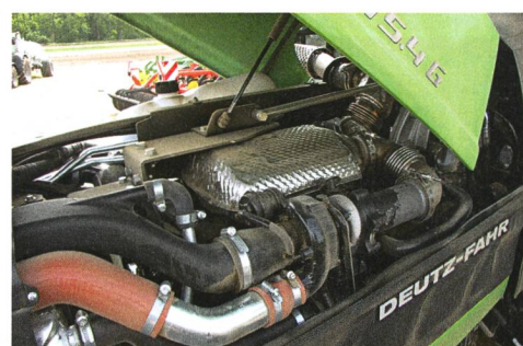
Logé au-dessus du moteur, le catalysateur à oxydation diesel (DOC) prend peu de place.
