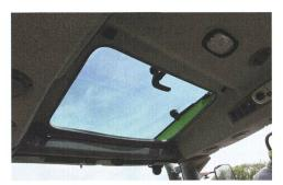
La fenêtre de toit permet de garder l'œil sur les outils frontaux en position haute.
