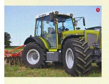
O Le Rigitrac SKH 120 est le plus grand des tracteurs Rigitrac, qui comptent désormais trois classes de puissance. Ces véhicules à entraînement hydrostatique ont une direction sur les quatre roues. L'articulation entre la partie avant et arrière du châssis améliore considérablement leur potentiel d'adhérence et de traction dans les pentes. Les Rigitrac sont construits par Rigitrac Fabrique de tracteurs SA à Küssnacht am Rigi (SZ), une filiale de l'entreprise familiale Sepp Knüsel.
