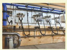
La paroi de traite expérimentale sert à analyser l'influence des différents types d'installations et de montage sur la stabilité du vide de la machine à traire.
