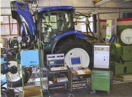
Tests de tracteurs rigoureux: A Tänikon, Agroscope mesure la consommation d'énergie et les émissions des véhicules agricoles.
