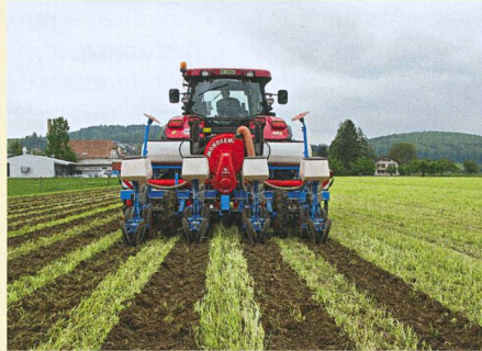
Le semis sur bandes fraisées est un développement suisse bénéfique pour le rendement sûr du maïs et la protection efficace du sol.
