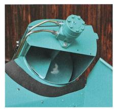
Les moteurs hydrauliques sont avantageux lorsqu'une transmission de puissance mécanique n'est pas possible. Cependant, la capacité du moteur hydraulique doit correspondre au débit volumique du système hydraulique ou le débit volumique doit être adapté aux besoins au moyen d'une soupape de régulation.
