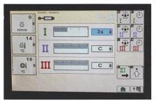
Ecran avec visualisation des raccordements hydrauliques du tracteur pour les consommateurs externes. Le débit a été réduit au raccordement I (vert). Des soupapes externes de régulation ne sont plus nécessaires.
