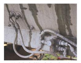
Régulation du débit volumique d'une citerne à pression pour le moteur hydraulique interne entraînant le brasseur. De telles applications présentent un risque accru de contamination de l'huile, avec les dommages qui en découlent.
