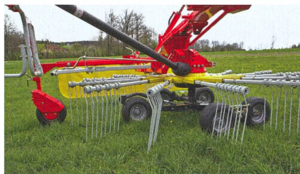
Plusieurs constructeurs, à l'instar de Pöttinger, proposent cet accessoire : une roue d'appui pivotante supplémentaire pour travailler en terrain inégal.
