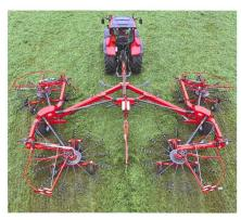
L'Hibiscus 1515 CD Profi est construit autour d'un châssis en V. Les roues de transport se déploient vers l'extérieur des rotors lorsqu'on met la machine en position de travail.
