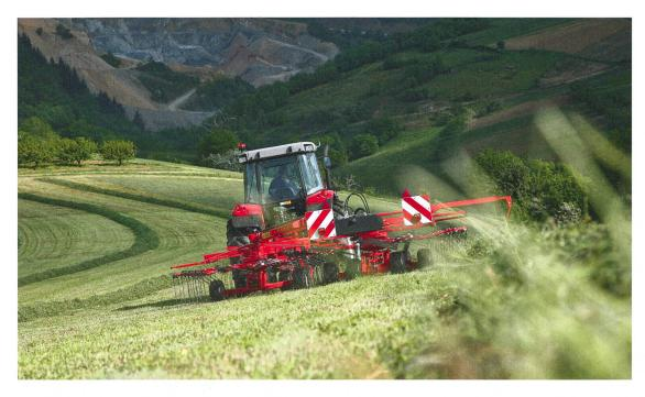
Kuhn propose des andaineurs articulés en quatre largeurs de travail, de 5,4 à 8,8 m. Avec une machine comme celle-ci, le rotor arrière est en mesure de stabiliser la machine dans une pente, grâce à sa direction.
