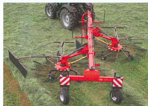
Sur cet andaineur latéral Vicon, l'avance en crabe permet de former soit un, soit deux andains. Ce type de construction est un peu plus avantageux qu'un bras télescopique.
