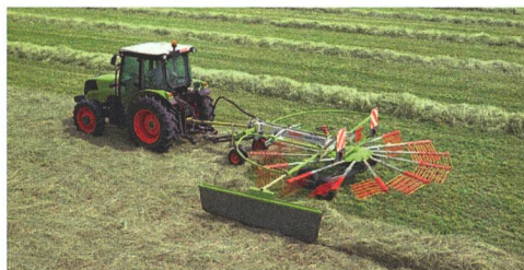
Le Liner 550 T de Claas est, avec ses 5,5 m de largeur de travail, le plus grand des andaineurs monorotor. Il est posé sur un train roulant à quatre roues, plus deux roues d'appui à l'avant du rotor.
