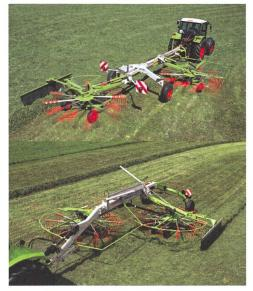
A côté de son andaineur latéral standard (en bas), Claas propose une version meilleur marché du Liner 1250 dont les roues de transports sont fixées au milieu de la poutrelle, entre les deux rotors. Le centre de gravité de cette machine est abaissé.
