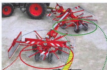
Le R+1410 SB de JF est le seul andaineur articulé avec direction automatique. Décalé, l'élément arrière suit un tracé parallèle au rotor avant, évitant au conducteur de devoir le guider manuellement dans les courbes.
