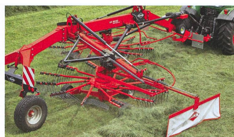
Les bras de cet andaineur latéral Kuhn sont équipés d'un dispositif télescopique permettant de régler la ligne de l'andain et, dans une certaine mesure, la largeur de ramassage.
