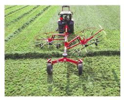
Le 10065 Pro de Fella modifie automatiquement le positionnement des dents de ramassage lorsqu'on le soulève, ce qui permet d'obtenir une meilleure garde au sol.
