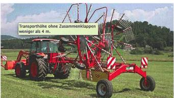
SIP offre des andaineurs centraux avec transmission en Y permettant de relever un rotor pour andainer dans des passages étroits.
