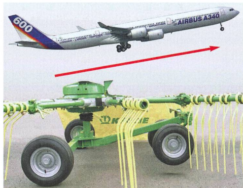
Quelques fabricants, à l'exemple ici de Krone, imitent le comportement de l'avion au décollage : lorsqu'on abaisse et relève l'andaineur, ses roues arrière gardent le contact avec le sol pour éviter aux dents d'aller s'enfoncer dans le sol.
