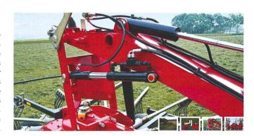
de l'andaineur suit toujours fidèlement une trace parallèle à la partie avant, y compris dans les courbes. Le chauffeur n'a plus qu'à se concentrer sur le rotor avant.
