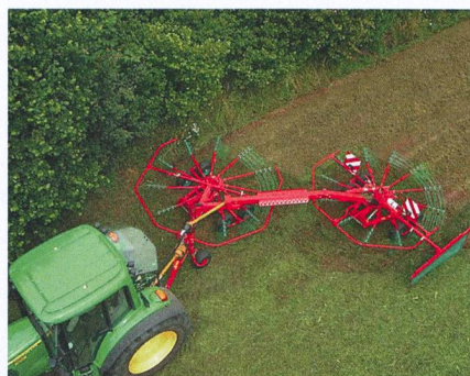
Grâce au «SideShift», l'andaineur articulé de Kverneland peut se faufiler jusque sous les arbres. Orienté dans l'autre sens, il permet d'andainer sans que le tracteur ne roule sur le fourrage.
