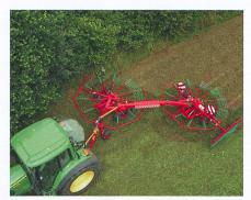
Grâce au «SideShift», l'andaineur articulé de Kverneland peut se faufiler jusque sous les arbres. Orienté dans l'autre sens, il permet d'andainer sans que le tracteur ne roule sur le fourrage.
