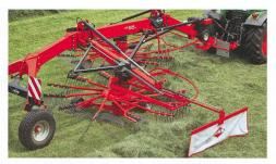
Les bras de cet andaineur latéral Kuhn sont équipés d'un dispositif télescopique permettant de régler la ligne de l'andain et, dans une certaine mesure, la largeur de ramassage
