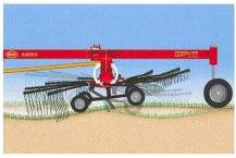
Avec le système Terra Link de Kverneland, le rotor est maintenu librement au sol, dont il suit le relief grâce aux roues d'appui.
