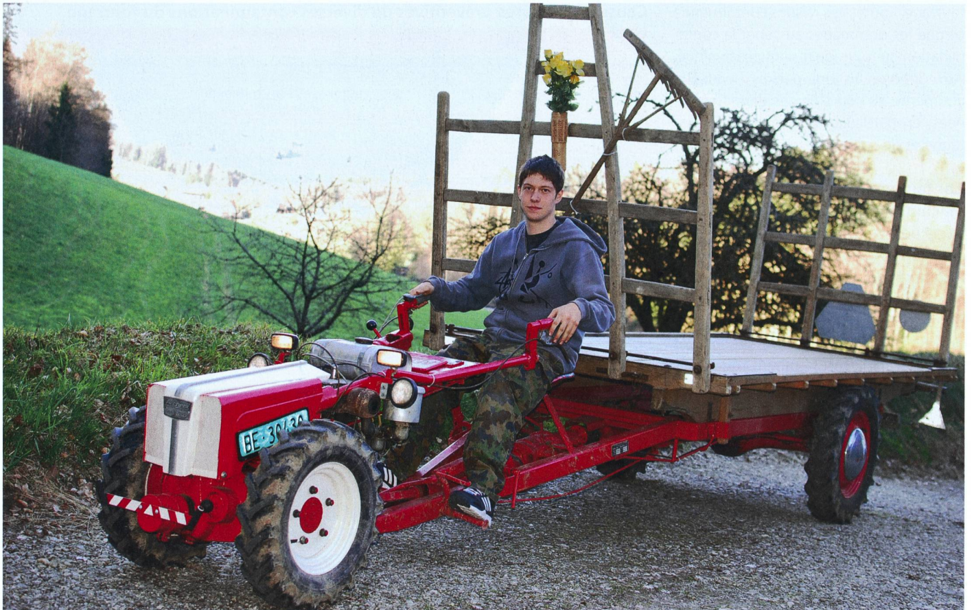
Martin Weber aime bien prendre le guidon de son Aecherli MA-350 B de 1986 avec sa remorque à prise de force. La machine est entraînée par un moteur MAG-1045 et possède une transmission à 12 vitesses et toute une gamme d'accessoires. (Photos : Dominik Senn)
