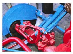
Côté droit de la transmission de l'Aecherli Standard: deux leviers sont pour les marches avant et deux autres pour les marches arrière. Lorsqu'on passe la marche arrière, la marche avant est automatiquement décrabotée.
