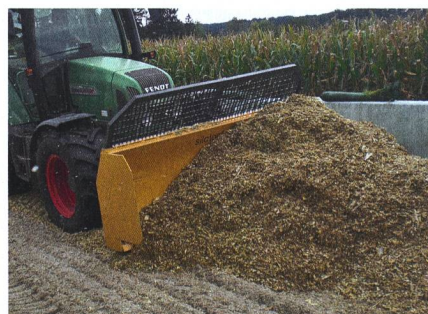
On voit ici à gauche la semelle de 25 cm de la lame qui l'empêche de plonger dans la masse de fourrage.
