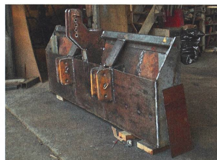
Cette lame en construction est dotée d'une double paroi créant un volume pour du ballast (sable ou gravier) supplémentaire.
