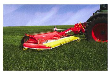
Les conditionneuses ne doivent pas broyer les plantes en détruisant leur cuticule (qui sert à les protéger contre l'évaporation).
