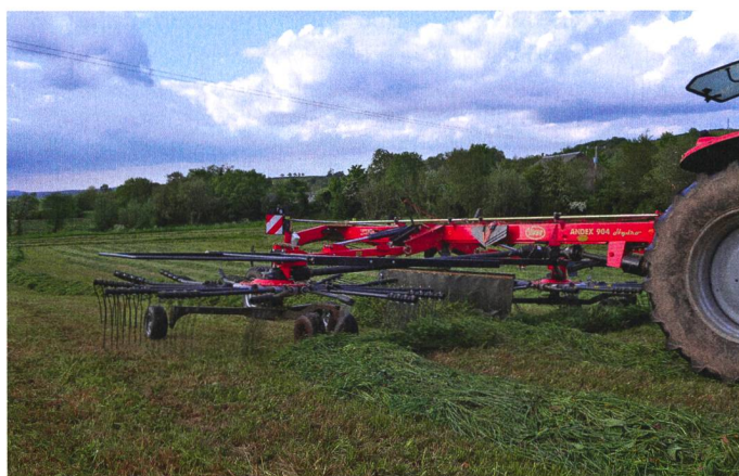
Les machines de fenaion rotatives endommagent moins le fourrage s'il repose sur une pelouse à quelques centimètres du sol.
