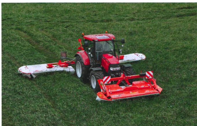
Les faucheuses rotatives dotées de lames mesurant 6 centimètres permettent d'obtenir de l'herbe haute de 7 à 8 centimètres. (Photos d'usine)
