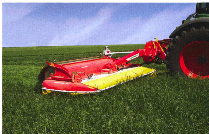
Les conditionneuses ne doivent pas broyer les plantes en détruisant leur cuticule (qui sert à les protéger contre l'évaporation).
