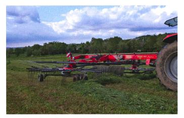
Les machines de fenaison rotatives endommagent moins le fourrage s'il repose sur une pelouse à quelques centimètres du sol.
