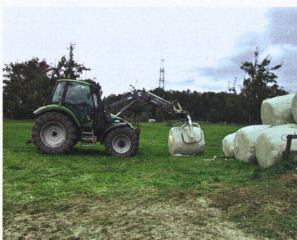
La pince est un outil peu coûteux pour transbahuter des balles enrubannées.
