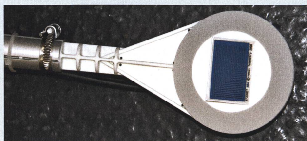
Le détecteur d'humidité des feuilles utilisé par les stations effectue des mesures basées sur le principe de la conductivité.
