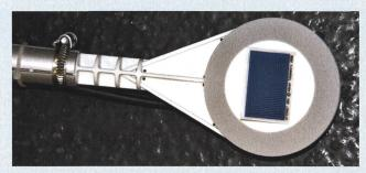
Le détecteur d'humidité des feuilles utilisé par les stations effectue des mesures basées sur le principe de la conductivité.
