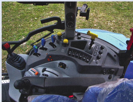
Les changements de rapports sous charge se font au moyen des boutons oranges placés au milieu de la console latérale, mais malheureusement pas sur l'accoudoir.
