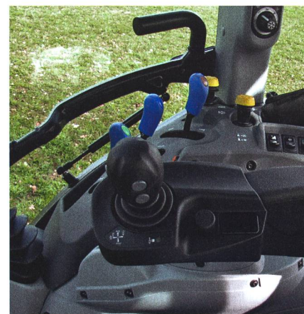
Le joystick et ses commandes électroniques peuvent s'actionner depuis l'accoudoir.
