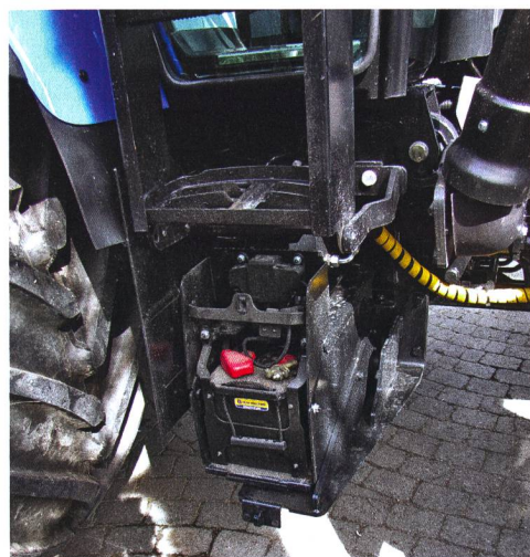
La batterie se trouve au-dessous de la marche droite et est très accessible.
