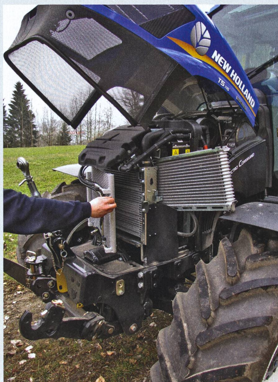
Le radiateur avant se rabat, et le radiateur d'huile peut s'extraire du système.
