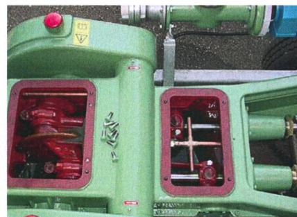
Sur les pompes Meier SA, le carter de l'embellage et la soupapierie sont complètement séparés. Les tuyaux visibles par l'ouverture de droite alimentent constamment les bielles en huile.
