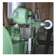
Les pompes Meier SA peuvent être dotées en option d'une soupape de surpression électronique. En combinaison avec un variateur de vitesse, elle permet de limiter automatiquement la pression.
