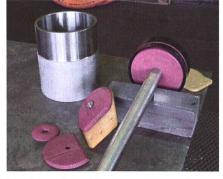
Les pistons à double effet coulissent dans un cylindre en acier dont la paroi interne est revêtue d'une couche spécialement dure pour la protéger de l'usure. (Photos d'usine)
