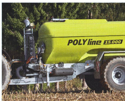
Les citernes en polyester et en matières synthétiques permettent de gagner quelques kilos sur le poids à vide des remorques.
