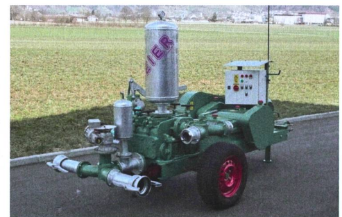
Un cadre en profilés en U confère sa stabilité à cette pompe et permet de la doter facilement d'un chariot pour la transporter d'une exploitation à l'autre.
