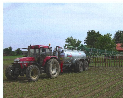
Pour les protéger de la corrosion, les cuves en acier sont galvanisées, avec parfois un revêtement supplémentaire.
