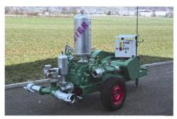
Un cadre en profilés en U confère sa stabilité à cette pompe et permet de la doter facilement d'un chariot pour la transporter d'une exploitation à l'autre.
