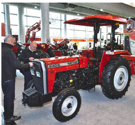
Les petits tracteurs standards sont commercialisés seulement avec un arceau de sécurité. Cela complique l'utilisation avec un frontal ou un treuil; le conducteur n'est pas suffisamment protégé.
