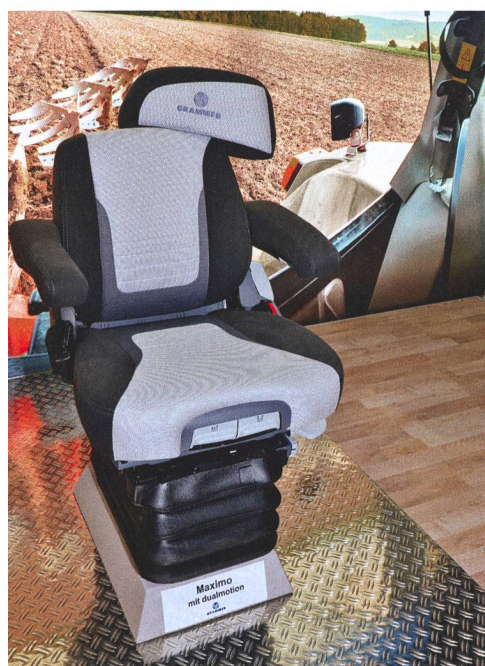
L'appuie-tête mobile de Grammer facilite le marche-arrière et améliore l'ergonomie.
