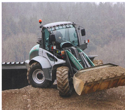
Cet Herkules est dans une posture difficile, mais son châssis lui confère une bonne stabilité et le moteur placé à l'arrière agit comme contrepoids.
