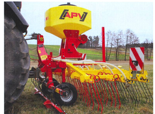
La herse étrille aère et défait le feutrage de la pelouse. Elle favorise le tallage des graminées.
