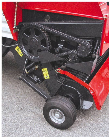
Les transmissions par chaîne restent des mécanismes simples et performants. Leur degré d'usure est facilement observable, ce qui permet de les remplacer à temps.
