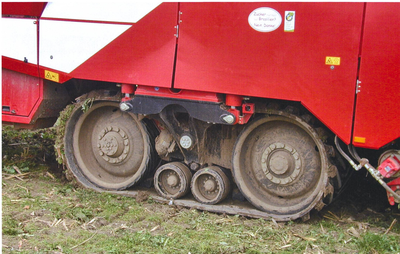
Les transmissions hydrauliques avec moteurs intégrés dans les moyeux sont aujourd'hui courantes sur les machines de récolte et de chantier. Seront-elles un jour remplacées par des moteurs électriques, d'un meilleur rendement ? (Photos : Ruedi Gnädinger)
