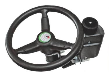
Pour automatiser le guidage par satellite d'un véhicule en postéquipement, on monte un moteur électrique sur le volant.
