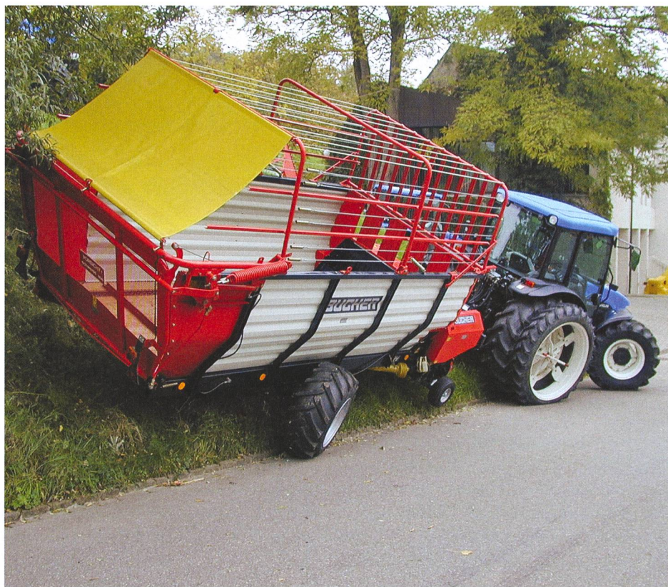
Sur les petites remorques, les essieux directionnels sont soit entièrement mécaniques (à tiges), soit à vérins hydrauliques de poussée et de traction. Sur les grandes remorques, ce genre de mécanisme n'est plus utilisable. La force nécessaire étant trop élevée, on utilise des directions assistées (souvent électrohydrauliques, alimentées par le circuit du tracteur).
