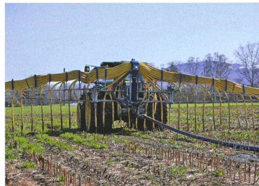
Lorsque le lisier est épandu par tuyau, le passage avec le tonneau à pression est éliminé, d'où une charge sur le sol sensiblement réduite.
