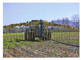
Lorsque le lisier est épandu par tuyau, le passage avec le tonneau à pression est éliminé, d'où une charge sur le sol sensiblement réduite.
