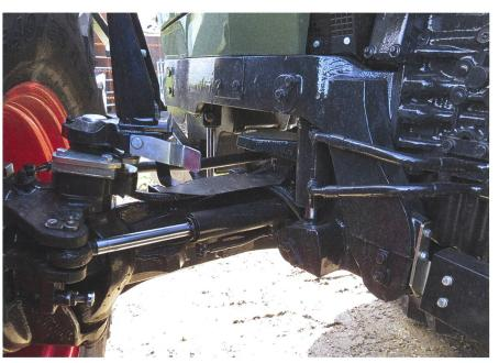
Un train avant signé SDF avec une suspension hydraulique en option.
