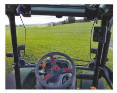
Une cabine bien éclairée, une visibilité panoramique: l'échappement est fixé au montant droit et aucun filtre à particules ne cache la vue.
