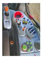
Une console regroupe les commandes que l'œil peut facilement embrasser grâce aux couleurs spécifiques à chaque groupe de fonctions: distributeurs hydrauliques, relevage arrière, prise de force et moteur/transmission/frein de stationnement.
