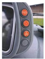
Sur le tableau de bord, trois interrupteurs permettent d'enclencher le freinage sélectif de la remorque, l'« accélérateur » de la direction (SDD) et la suspension du train avant.
