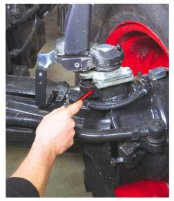
Le capteur d'angle de braquage pour l'ASM se trouve à cet endroit bien protégé.
