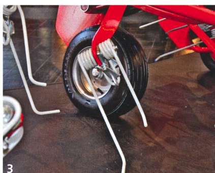
1 Les dents se distinguent par leur nombre de spires, leur diamètre et la longueur des griffes. (Photos : Ruedi Hunger)
