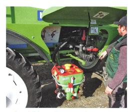
Le dispositif de remplissage avec bac incorporateur permet de gagner du temps.
