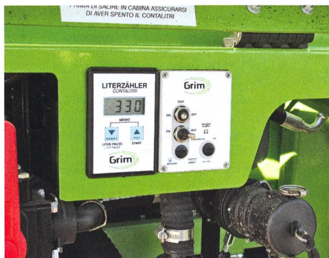
Lors du remplissage (en bas) comme en cours de traitement, le conducteur est en permanence informé du volume restant dans le réservoir.
