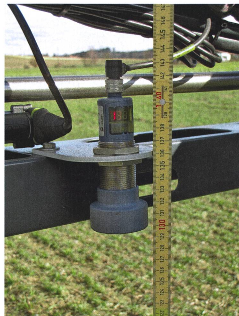
Deux radars de ce genre surveillent et gèrent la hauteur de la rampe.
