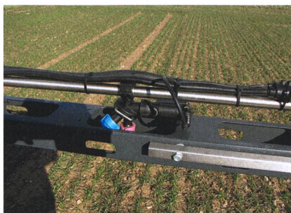
Chaque sortie est équipée d'un porte-buses à trois buses et d'une vanne magnétique.
