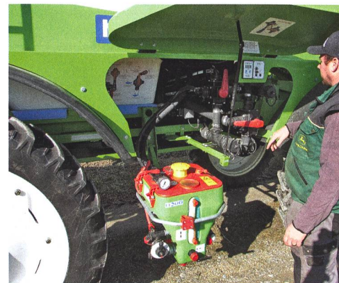
Le dispositif de remplissage avec bac incorporateur permet de gagner du temps.
