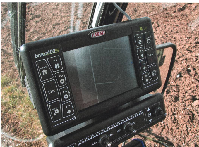
A l'issue du traitement, l'ordinateur de bord indique sur la carte de la parcelle quelles étaient les buses ouvertes ou fermées en chaque point de la surface.
