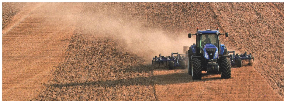
Le chisel est une machine destinée au travail superficiel du sol. Utilisé convenablement, il fournit du bon travail à de hautes capacités. (Photo d'usine)
