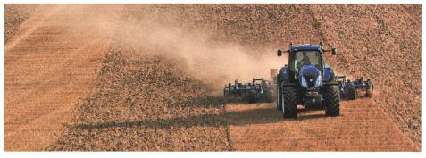
Le chisel est une machine destinée au travail superficiel du sol. Utilisé convenablement, il fournit du bon travail à de hautes capacités. (Photo d'usine)
