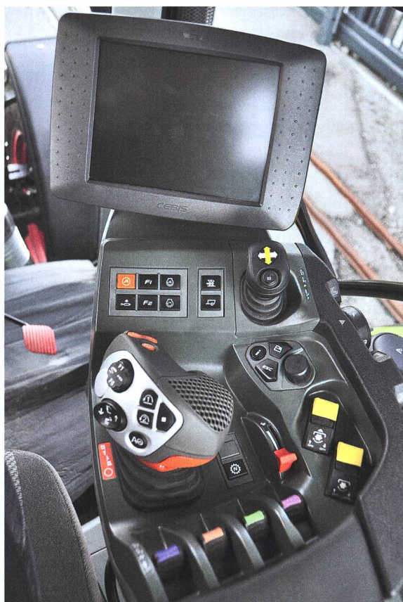
Toutes les commandes sont groupées à portée de main sur l'accoudoir, avec le levier Cmotion et le terminal Cebis.
