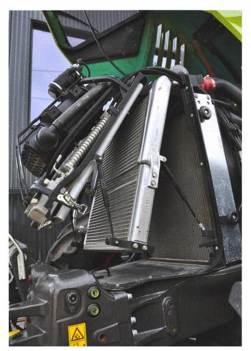
Le capot d'une pièce s'ouvre tout grand et permet d'accéder aux éléments de refroidissement qui se déplient vers l'avant pour faciliter le nettoyage.
