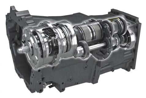
La transmission Hexashift avec ses trois trains planétaires pour les rapports enclenchables sous charge (à g.), son double embrayage multidisques (au centre) pour l'inverseur et les quatre gammes de vitesses (à d.).
