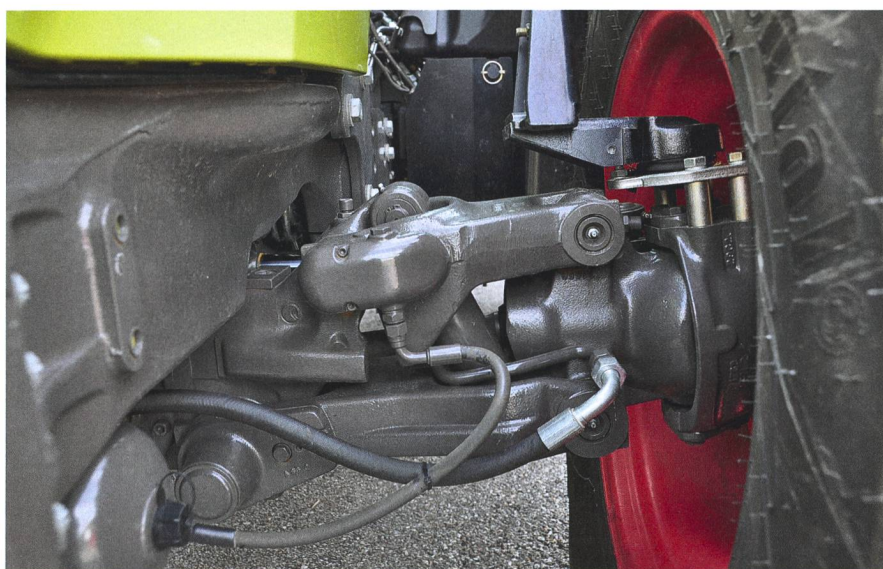
La suspension à bras oscillants avant contribue au confort de conduite du tracteur.
