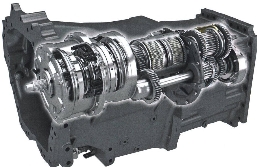
La transmission Hexashift avec ses trois trains planétaires pour les rapports enclenchables sous charge (à g.), son double embrayage multidisques (au centre) pour l'inverseur et les quatre gammes de vitesses (à d.).
