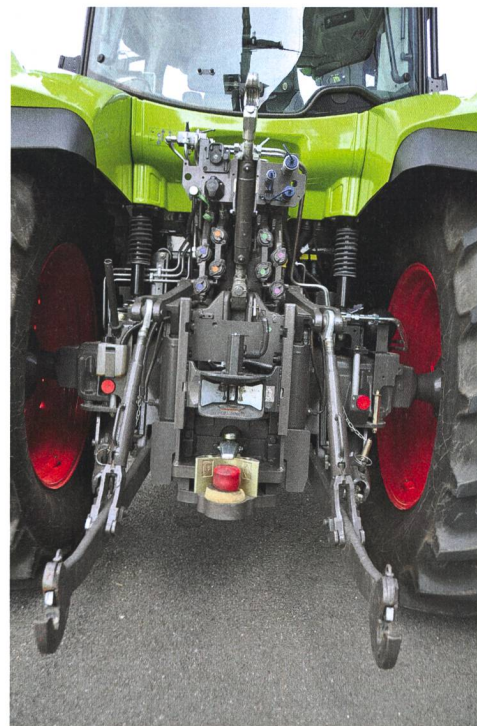
L'espace arrière est bien dégagé et permet d'accéder aisément aux prises hydrauliques.
