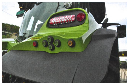
Sur l'aile arrière se trouvent des commandes pour la prise de force, le relevage et un distributeur hydraulique. La commande de prise de force est sécurisée.
