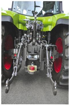
L'espace arrière est bien dégagé et permet d'accéder aisément aux prises hydrauliques.
