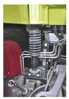
La résistance des quatre points de suspension mécanique de la cabine est réglable individuellement.
