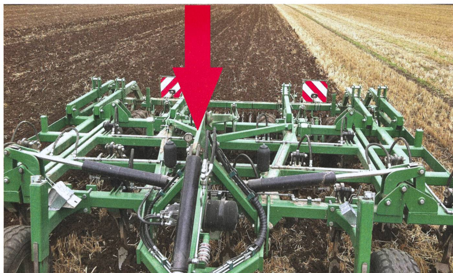
Le vérin du timon d'attelage du Komet KAS de Kerner est doté de capteurs assurant une adaptation automatique au relief.
