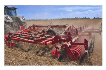
à deux rangs. Elle a accordé une plus grande attention au tracteur, ce qui a permis de réduire la force de levage. Le bras supérieur se décline en trois positions. Doté de deux positions sur une chape d'attelage inclinable, le Synkro s'adapte parfaitement à chaque tracteur. La tige incurvée du soc à ailettes et le
