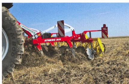
Le cultivateur Synkro de Pöttinger a une hauteur de 80 cm et un espace interrang de 75 cm, soit suffisamment de place pour la matière organique.
