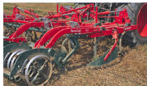
Les déflecteurs de paille et les disques étoile du VN-TerraCult garantissent que tout (paille) soit bien réparti et forme des sillons ordonnés.
