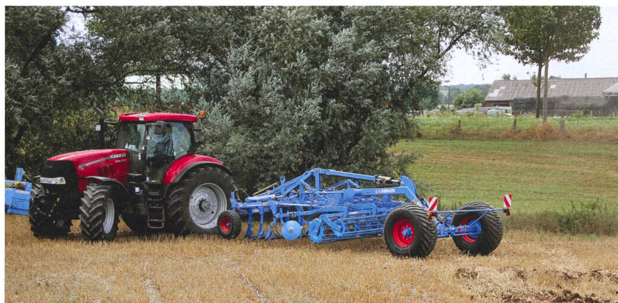
Le cultivateur Lemken est pourvu à l'arrière d'un essieu de transport qui le dispense de soulever le Karat long de 4 à 5 m.
