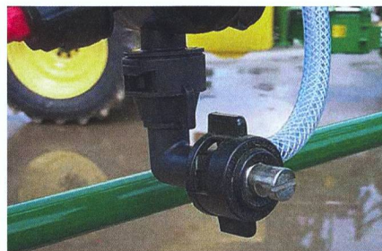
Sur les buses John Deere TwinFluid, on peut contrôler le rapport entre la pression de l'air et celle de la bouillie pour produire des gouttes de taille idoine.
