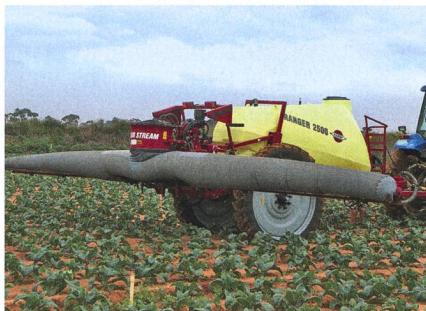
Avec le célèbre Hardi Twin, le brouillard de traitement est pulsé à l'intérieur de la végétation.
