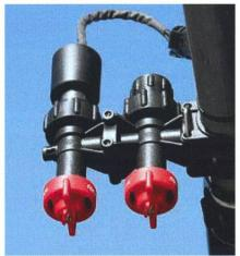
Sur le SharpShooter, la buse à vanne magnétique (à gauche) est complétée par une buse normale.
