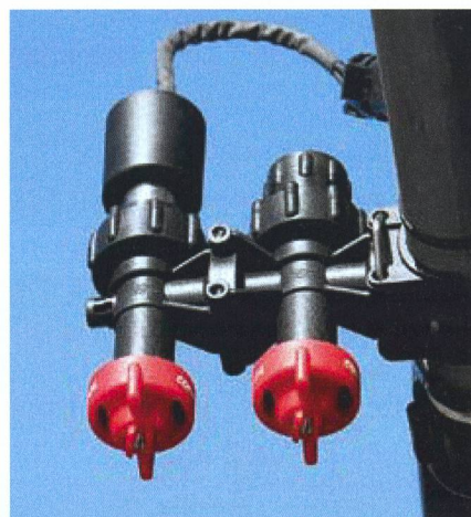
Sur le SharpShooter, la buse à vanne magnétique (à gauche) est complétée par une buse normale.
