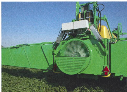
Sur le Dammann Dual Air System, le brouillard de bouillie est protégé devant et derrière par un flux d'air.
