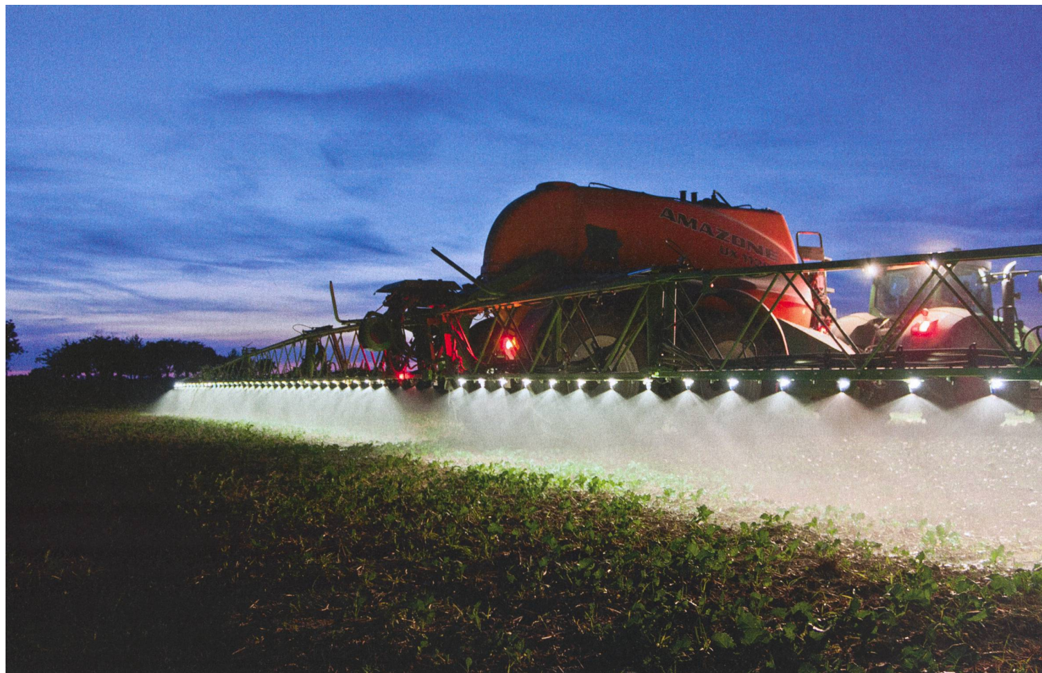
L'éclairage LED permet de vérifier à l'oeil le fonctionnement de chaque buse, y compris de nuit. (Photos d'usine)
