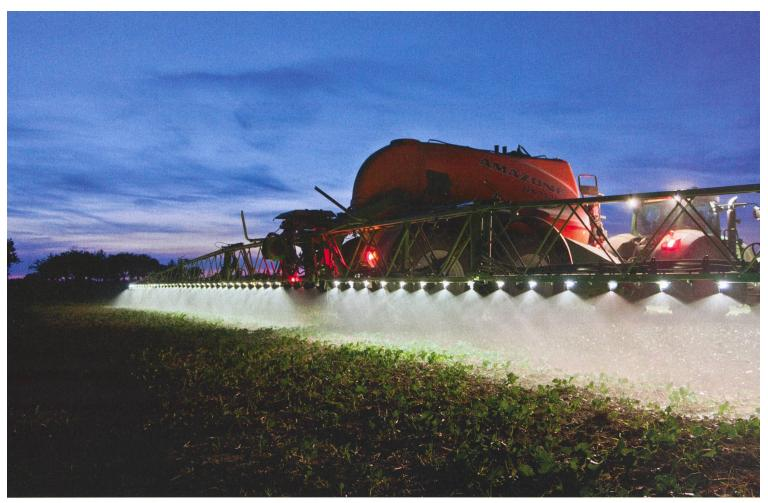
L'éclairage LED permet de vérifier à l'oeil le fonctionnement de chaque buse, y compris de nuit. (Photos d'usine)
