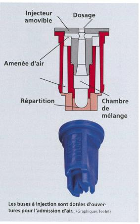
temps sont apparues de nombreuses variantes de buses offrant une meilleure couverture pour des pressions plus basses, dès 2 à 4 bars, et un domaine d'utilisation élargi. Il existe désormais aussi des buses à injection plus courtes. L'illustration ci-dessous montre ainsi une buse à double jet plat Teejet Al3070 spéciale pour le traitement des épis. Elle est dotée d'un répartiteur et d'une pastille produisant un double jet plat dirigé à 30 degrés vers l'avant et à 70 degrés vers l'arrière.
