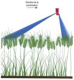
La buse Al 3070 à injection et double jet pinceau est spécialement conçue pour traiter les épis. Elle conjugue les avantages d'une buse à injection et ceux du double jet.
