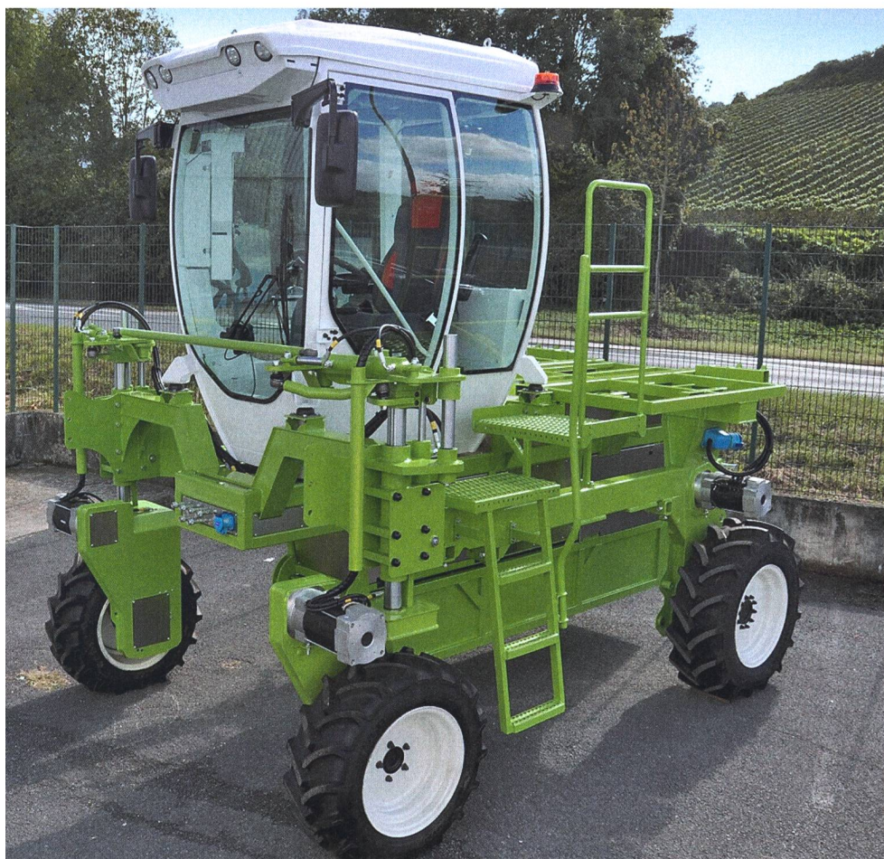
L'enjambeur électrique (Keimer) démontre que la motorisation électrique est possible pour des outils plus puissants. (Photo : service de presse)
