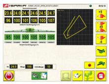
Ce système de commande des buses basé sur des capteurs et développé par Fritzmeier permet l'utilisation optimale des produits phytosanitaires. (Photo: Fritzmeier Umwelttechnik)
