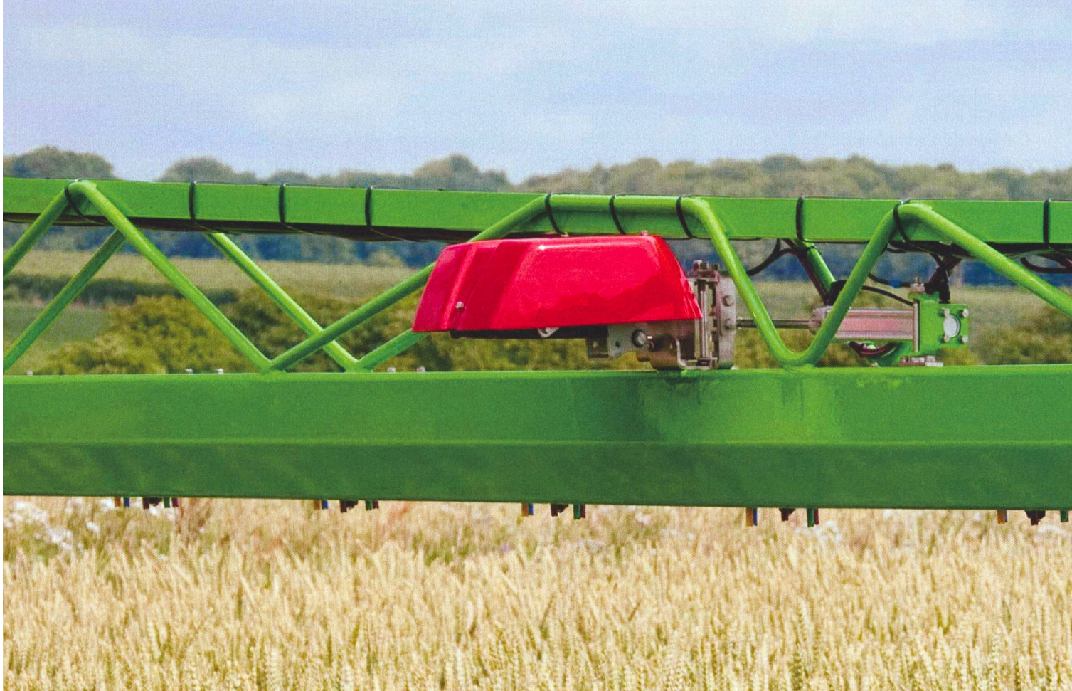
La tête de mesure envoie les valeurs mesurées au terminal dans la cabine. (Photo: Fritzmeier Umwelttechnik)
