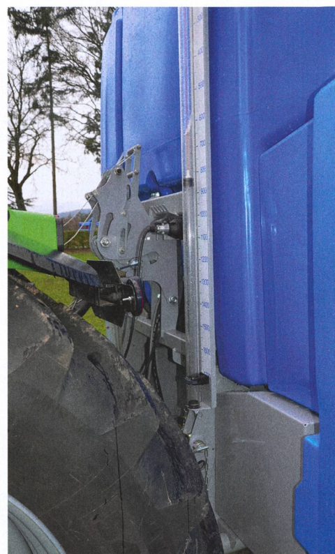
Les pulvérisateurs portés laissent peu de marge de manœuvre au tracteur. De nouveaux attelages et un centre de gravité favorable améliorent la liaison et réduisent les besoins de force de levage.
