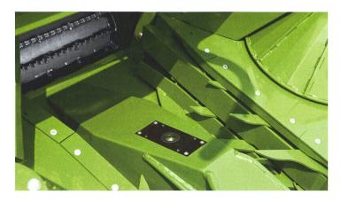
Les capteurs optiques montés au milieu des becs à maïs du BiGX Krone déterminent le degré de maturité des plantes et régulent le hacheur en conséquence.
