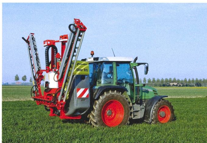
Le repli du ZETA de Kverneland se fait exclusivement en vertical.
