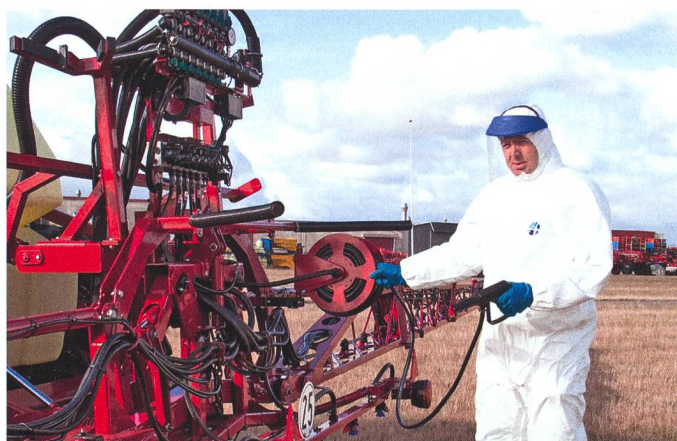
Avec l'équipement adéquat, le nettoyage externe se fait déjà au champ, avant que les résidus aient le temps de sécher.
