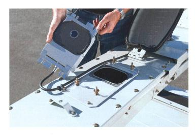
Le capteur NIR sur la goulotte des ensileuses Claas est relié par fibre optique au spectromètre dans la cabine.
