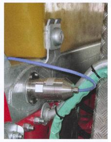
Chez Zunhammer, le capteur NIR du système VAN-Control mesure la teneur en fertilisants du lisier lors du remplissage de la citerne.
