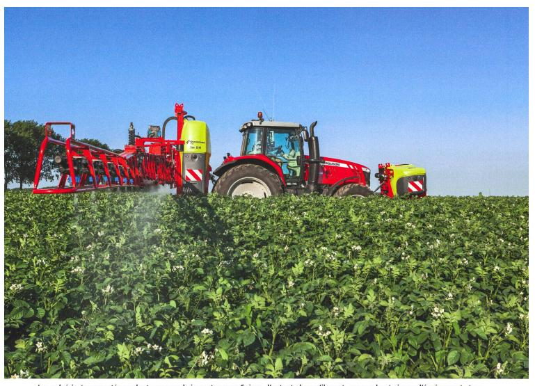
Les pulvérisateurs portés gardent une grande importance en Suisse, d'autant plus qu'ils sont, avec un haut niveau d'équipement et un réservoir frontal, techniquement équivalents à un pulvérisateur automoteur remorqué ou automoteur. (Photo d'usine)
