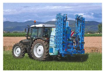
Cette rampe est déployée et repliée horizontalement. La rampe se redresse verticalement pour le transport.
