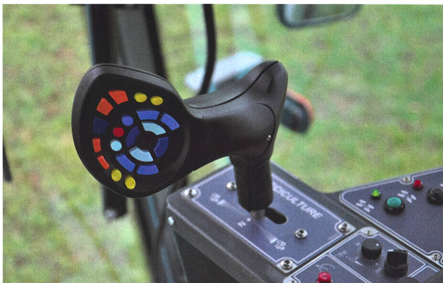
Le joystick multifonctions sans fil de Berthoud assure une liaison radio à une distance de 25 m.
