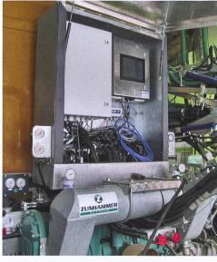
Le spectromètre NIR interprète les données du capteur et module l'épandage en fonction de la teneur en fertilisants du lisier.
