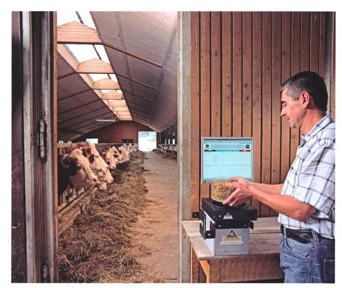
Les spectromètres NIR compacts, comme ici le HarvestLab de John Deere, peuvent aussi servir d'analyseurs mobiles pour les ensilages. (Photo: John Deere GmbH & Co. KG)
