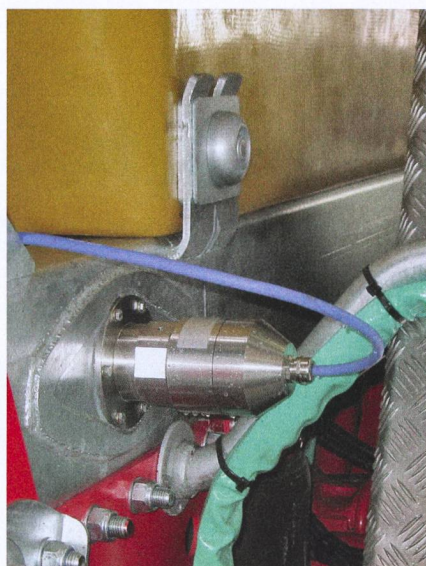
Chez Zunhammer, le capteur NIR du système VAN-Control mesure la teneur en fertilisants du lisier lors du remplissage de la citerne.
