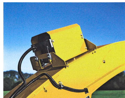
Ce spectromètre NIR, fruit d'un développement commun avec Zeiss, est placé sur la goulotte des ensileuses John Deere. Il analyse la récolte en continu et régule la longueur de coupe en fonction de son taux de matière sèche. (Photo : John Deere GmbH & Co. KG)
