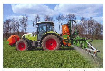
Tous les constructeurs importants augmentent le volume des pulvérisateurs portés par un système de réservoir frontal.
