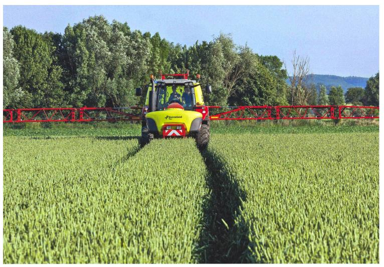
La combinaison des réservoirs frontal et arrière donne des « automotrices » qui doivent cependant être suffisamment utilisées, parce qu'elles mobilisent un tracteur. (Photos d'usine)
