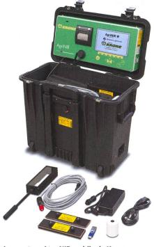
Le spectromètre NIR mobile de Krone permet d'analyser rapidement des plantes en bordure de champ ou à la ferme. Les résultats de la quantification de l'échantillon apparaissent au bout d'une petite minute à l'écran. (Photo: Maschinenfabrik Bernard Krone GmbH)
