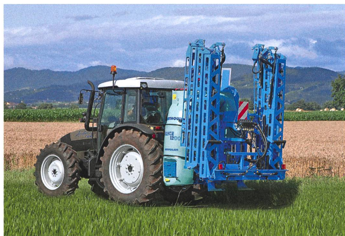
Cette rampe est déployée et repliée horizontalement. La rampe se redresse verticalement pour le transport.
