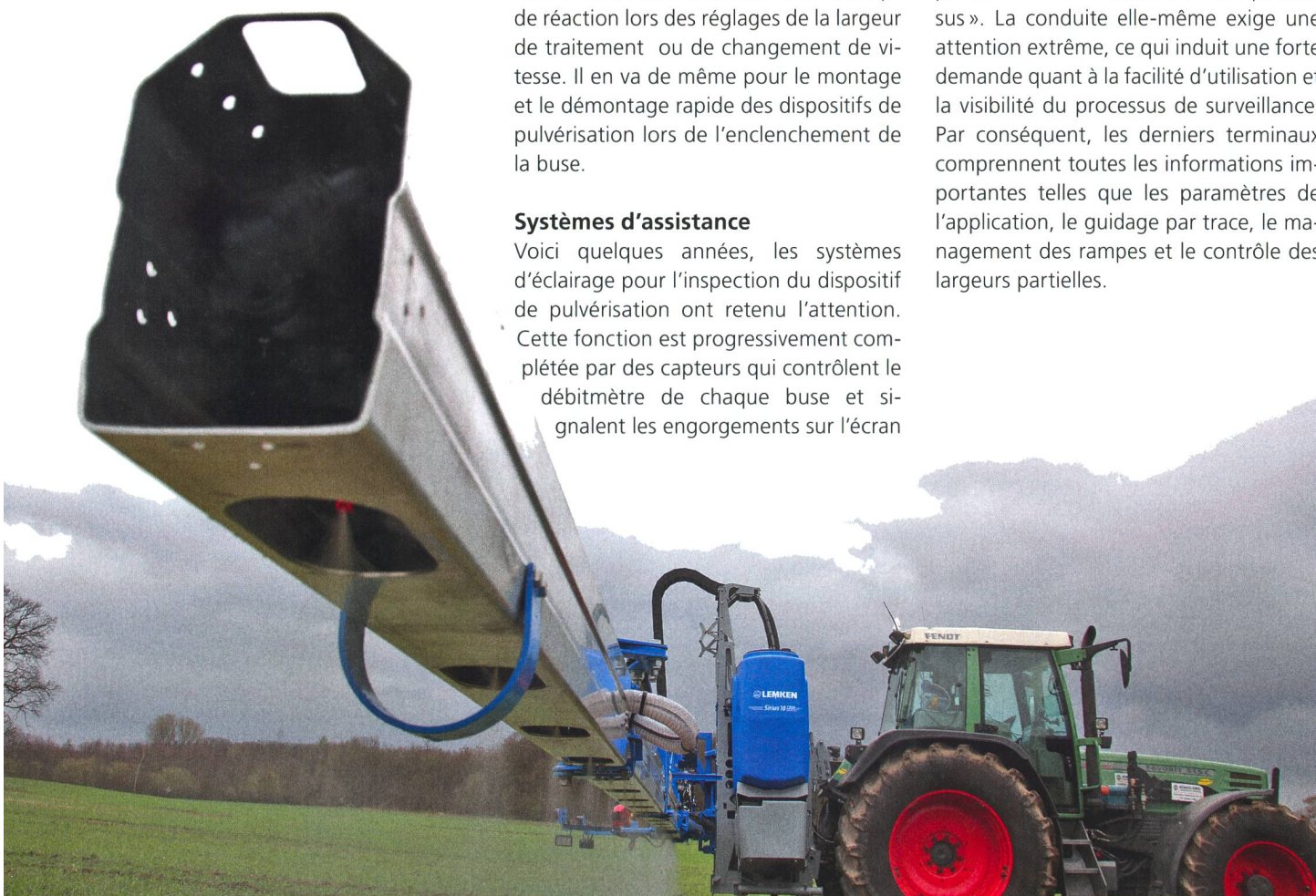
Une application régulière est obtenue grâce à l'amortissement des mouvements horizontaux et verticaux des rampes.
