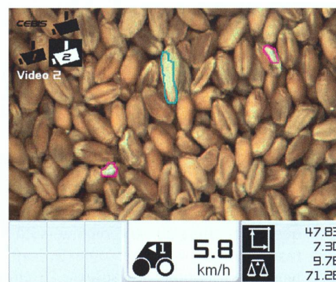
Sur l'écran, les objets « problématiques » présents dans la récolte apparaissent en couleur. Les images proviennent de la Grain Quality Camera de Claas.
