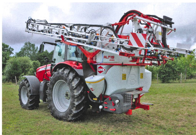
Le repli des rampes d'épandage en hauteur et latéral laisse du champ dans le secteur inférieur du pulvérisateur, mais élève le centre de gravité et la hauteur de transport.
