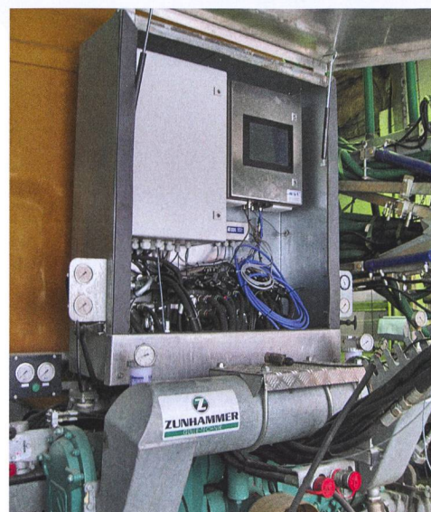
Le spectromètre NIR interprète les données du capteur et module l'épandage en fonction de la teneur en fertilisants du lisier.
