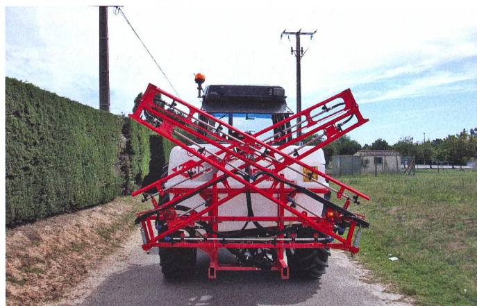
Le repli en X est pensé pour les rampes de la gamme de prix inférieure, qui sont actionnées manuellement.
