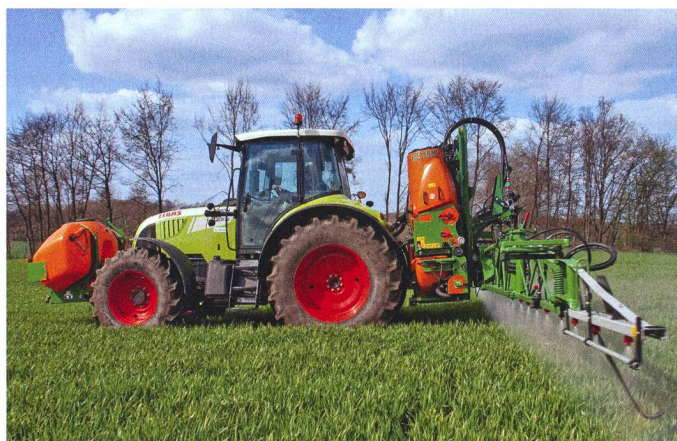
Tous les constructeurs importants augmentent le volume des pulvérisateurs portés par un système de réservoir frontal.
