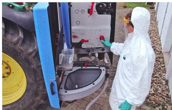
Les pulvérisateurs sont commandés de manière centrale sur le côté. La « centrale de commande » est protégée par un couvercle rabattable.
