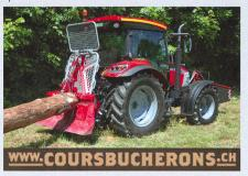
Un treuil est indispensable pour travailler en sécurité. Les tracteurs utilisés pour le débardage doivent être équipés d'une cabine homologuée. L'opérateur doit commander le treuil depuis un endroit sûr, p. ex. par radiocommande, à l'aide d'une longue corde ou depuis le poste de conduite.
