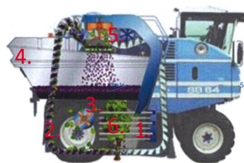
Fig. 1 Schéma général de fonctionnement 1. Tête de récolte, secoueur 2. Collecteurs-convoyeurs 3. Aspirateurs 4. Bennes 5. Grille 6. Ceps
