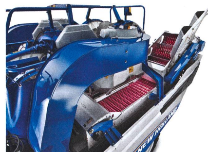
Des tables de tri embarqué toujours plus performantes. A gauche le Select Process de Pellenc et à droite l'OptiGrape de New Holland.
