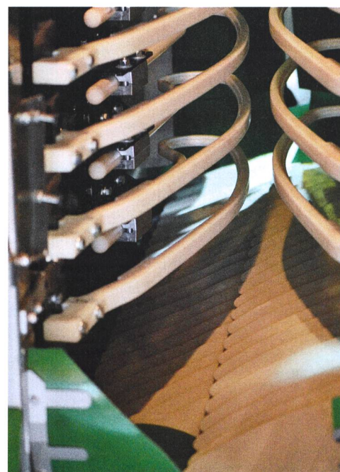
Collecteurs-convoyeurs : norias (à gauche) ou écailliers (à droite) avec secoueurs.
