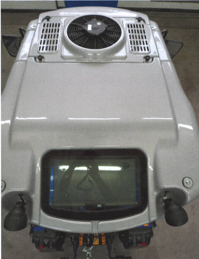
Vue sur le toit de la cabine du K600 avec son ventilateur en position protégée et la fenêtre permettant de suivre le travail d'une effeuilleuse, d'un élévateur ou d'un autre outil vertical.
