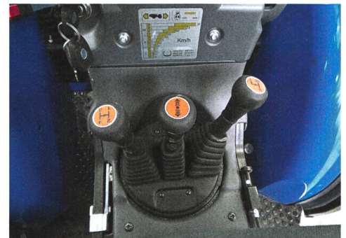
Les leviers sur leur support. La position des vitesses, à l'exception de l'inverseur, change lorsqu'on retourne le poste de conduite.
