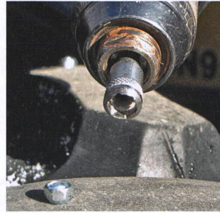
L'embout de vissage de forme conique peut s'enfoncer dans la gomme du pneu.
