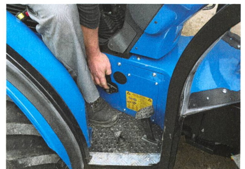
La manœuvre de la poignée de frein à main fonctionne en liaison avec la pédale de frein.
