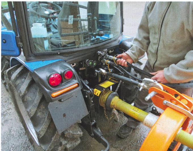
A l'arrière, la place est prévue pour monter 8 prises hydrauliques pour 4 branchements à double effet.
