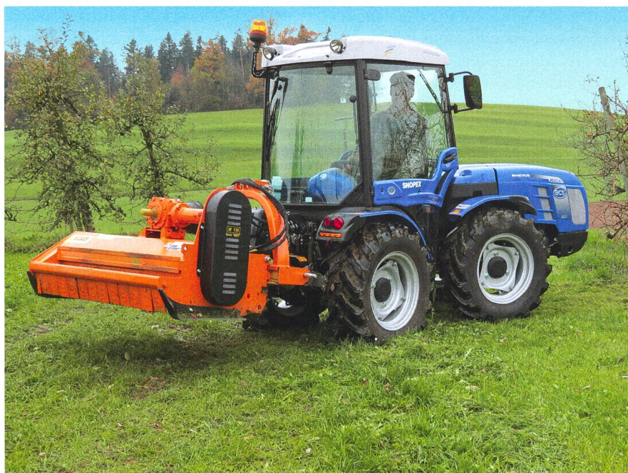
Malgré son poids relativement élevé, le broyeur ne pose pas de problème au tracteur qui bénéficie d'une bonne répartition de ses masses.
