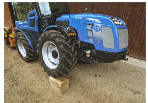
Le tracteur peut pivoter de 15° sur son axe grâce à l'« OS-Frame ».
