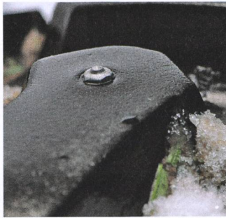
Le crampon correctement posé, sa pointe doit dépasser d'environ 3 mm de la gomme.
