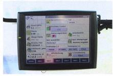
Sur l'AFS Pro 700 de Case-IH, la fonction Split permet à l'utilisateur de configurer individuellement les six fenêtres apparaissant à l'écran. (Photo: CASE IH Agriculture)
