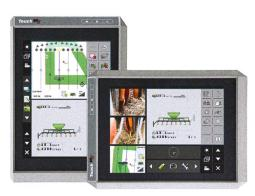
Le terminal TOUCH1200 de Müller-Elektronik dispose d'une interface tactile à commande intuitive qui peut afficher simultanément jusqu'à cinq applications, en format horizontal ou vertical. Le graphisme est optimisé pour être manipulé par touche d'écran. (Photo: Müller-Elektronik GmbH & Co. KG)
