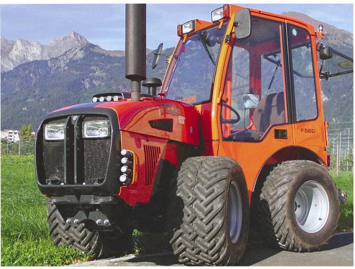
Des roues de dimensions équivalentes et une répartition du poids optimale assorties à des pneus adéquats assurent un transfert de puissance efficace. (Photo: Ruedi Hunger)
