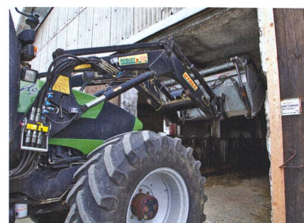
La commande du chargeur frontal Isobus permet par exemple de limiter la hauteur de chargement dans les bâtiments bas.
