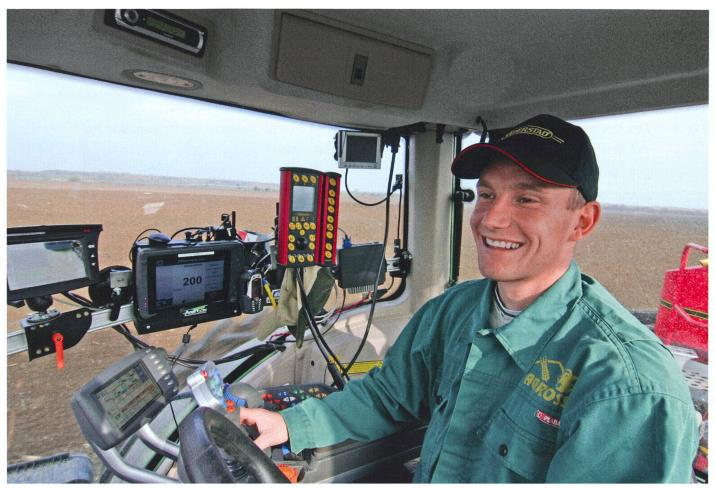
Une fonction-un terminal. Il y a quelques années, on ne pouvait y couper. Les cockpits d'aujourd'hui sont mieux ordonnés. Même lorsqu'on utilise simultanément plusieurs machines ou fonctions ISOBUS, un ou deux écrans suffisent. (Photo: Agro Con GmbH)
