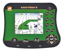
Chez Amazone, l'AMATRON 3 est l'appareil d'entrée de gamme pour accéder au monde des terminaux ISOBUS. Une touche permet de commuter d'une application à l'autre lorsque l'on doit gérer plusieurs instruments
