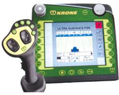
Le transfert de certaines fonctions de pilotage vers un levier multifonctions dans la cabine ou vers un joystick AUX est une façon de répartir et combiner les commandes entre touches, écran tactile et boutons. (Photo: Maschinenfabrik Bernard KRONE GmbH)
