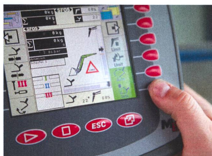
Sur le terminal, les fonctions de l'automate de chargement et de pesage peuvent être visualisées très clairement.
