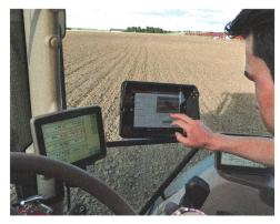
Un support d'iPad fait partie du nouveau E-Service de Väderstad. Avec l'application idoine, l'iPad se transforme en terminal pour semoir Tempo. Les fonctions sont accessibles via l'écran tactile de l'appareil ou par le clavier. (Photo: Väderstad GmbH)
