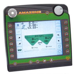
Le terminal ISOBUS CCI 200 se commande en touchant l'écran et, accessoirement, par des touches et un bouton rotatif. Un plus du branchement ISOBUS, cet appareil dispose d'une possibilité de liaison bluetooth ou wifi et, en option, d'un modem GSM pour «converser» avec d'autres appareils. (Photo: Competence Center ISOBUS e.V.)
