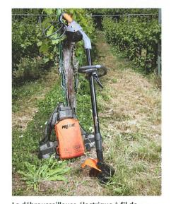
La débroussailleuse électrique à fil de Pellenc a déjà été testée; elle offre de grandes capacités avec sa batterie Lithium Ultra avec une autonomie d'au moins un jour de travail également.
