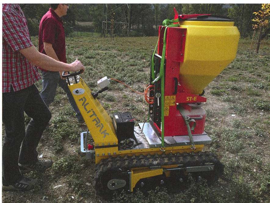
L'épandeur d'engrais monté sur le tracteur à chenilles électrique AliTrak constitue une variante pratique ; une puissance de 5-6 kW suffit parfaitement.
