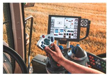
Sur le terminal Vario 10,4", le paramètrage des menus s'effectue en touchant l'écran ou avec les boutons de navigation. Le réglage de certaines valeurs se fait par un bouton rotatif. L'écran peut afficher jusqu'à quatre applications différentes. (Photo: AGCO GmbH)
