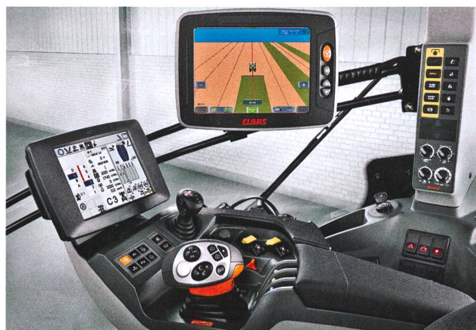
Le nouveau terminal S10 de Claas fait partie du programme EASY (Efficient Agriculture Systems), nom sous lequel Claas réunit l'ensemble de ses activités dans l'électronique. L'écran tactile affiche au choix une application unique, respectivement une image de la caméra, ou bien trois applications ou encore quatre images simultanément. (Photo: Claas Agrosystems KGaA mbH & Co KG)
