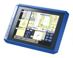
Le field-operator 450 de WTK-Elektronik est un terminal ISOBUS universel. Il dispose d'un nouvel écran tactile Triple-Action.
