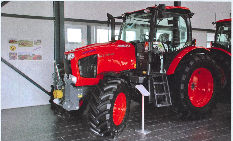
Kubota a lancé le M135GX qui satisfait aux normes antipollution en adoptant une vanne EGR et un filtre à particules. (Photo: Dominik Senn)
