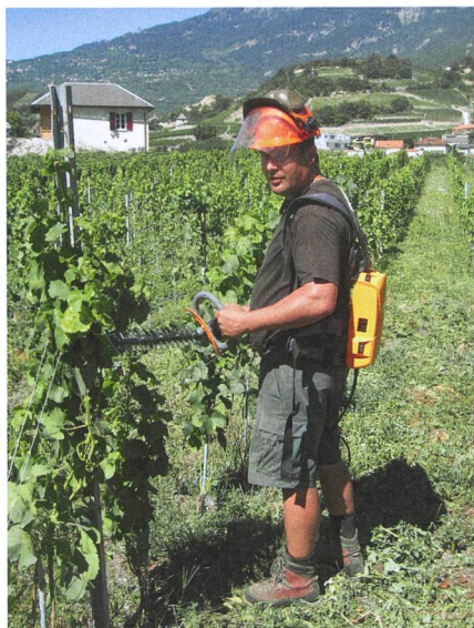
La batterie du taille-haie électrique offre une autonomie d'au moins un jour de travail. Il sera apprécié par les utilisateurs pour sa facilité d'utilisation et son fonctionnement silencieux.
