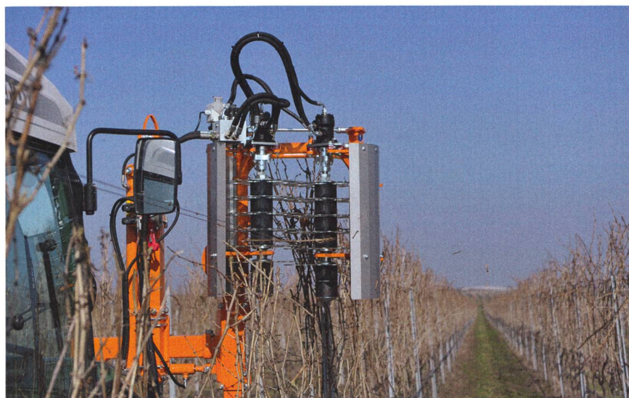
Plusieurs outils portés, ainsi cette machine de taille, sont entraînés hydrauliquement, ce qui impose des exigences particulières au système hydraulique. (Photo d'usine)
