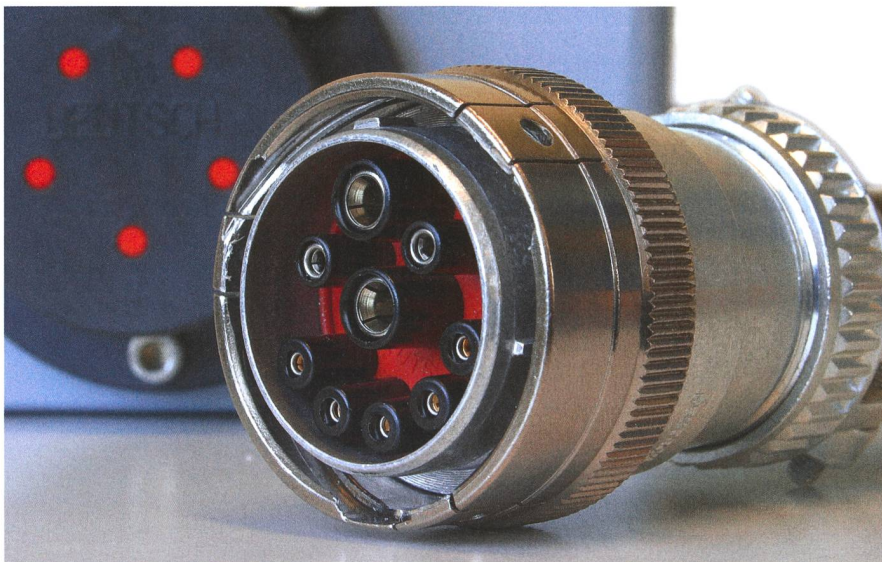
Les producteurs de technologie agricole se sont mis d'accord sur le plan mondial pour utiliser ISOBUS en tant que « langue et technique de transfert » pour la communication entre les périphériques et les tracteurs, ainsi que les PC. (Photo: Ruedi Hunger)
