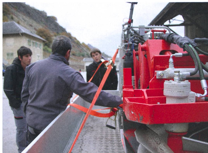
Lors des accélérations et des freinages, la vitesse se transforme en une énergie potentielle qui exerce de très fortes contraintes multidirectionnelles sur les sangles d'arrimage. Leur mise en place exige savoir-faire et professionnalisme.
