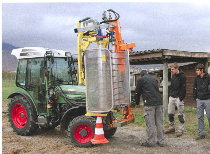
Matthieu Vergère montre comment signaler correctement la présence d'un outil encombrant et explique comment celui-ci influence négativement la dynamique du véhicule dans les courbes, et le déplacement de masse qu'il génère en position de travail.
