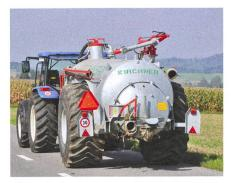
Une épandeuse à lisier doit également être correctement aérée avant d'y pénétrer. Ouvrir la partie arrière ne suffit pas!
