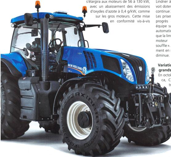
Selon New Holland, l'empattement de 3550 mm améliore la stabilité et l'efficacité du tracteur, que vient encore optimiser un système permettant de transmettre 100 % de la force de traction vers les roues.
