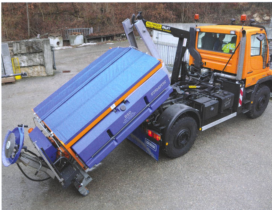
Un dérouleur permet de changer en quelques minutes des outils intégrés et donc d'utiliser et de rentabiliser de manière optimale un véhicule qui sert à l'entretien des routes en hiver.
