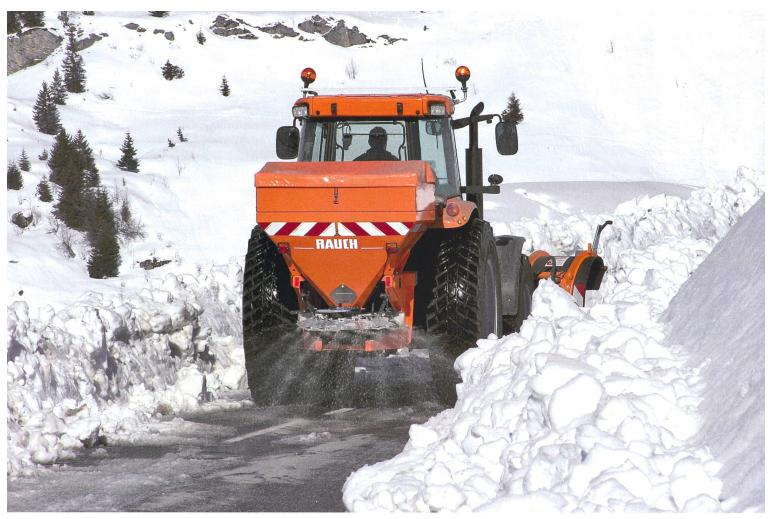
Un épandeur moderne pour l'entretien des routes en hiver se doit de pouvoir adapter son régime d'entraînement de disques et d'avoir une portée d'éjection limitée, une transmission hydraulique et des composants électroniques bien protégés. (Photos d'usine)
