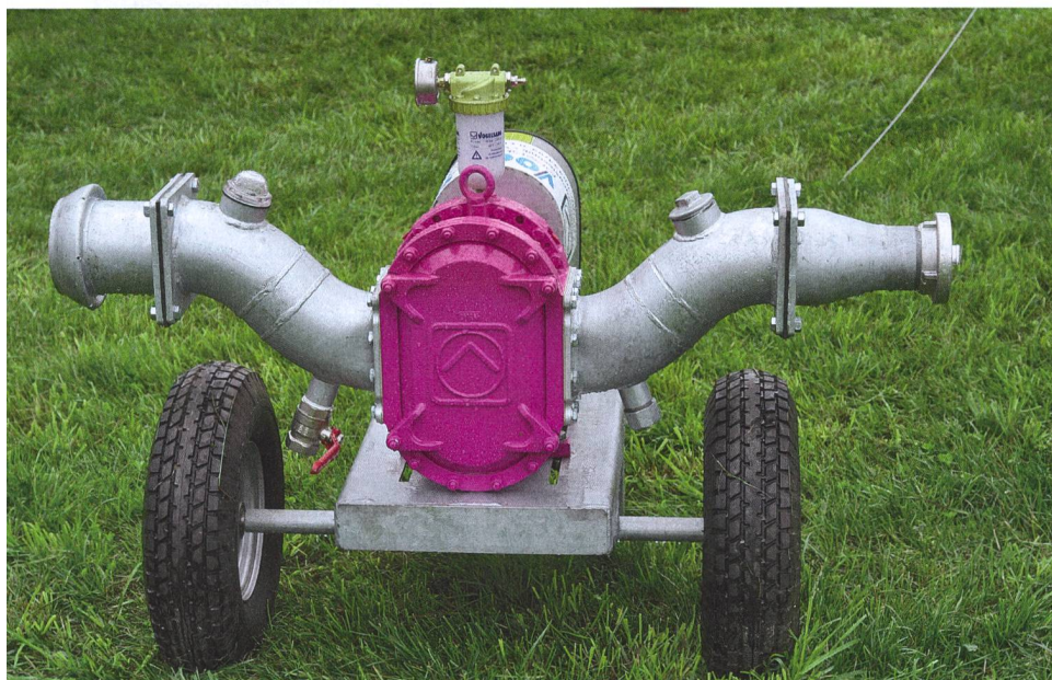
Les pompes modernes à quatre lobes avec géométrie HiFlow aspirent le lisier sans à-coup et avec une puissance constante. (Photos: Konrad Merk)
