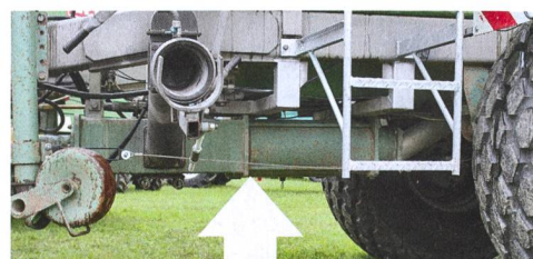
Les pompes excentrées à vis sans fin aspirent le long de l'axe de rotation. Elles sont fines et ne prennent que peu de place dans un tonneau.
