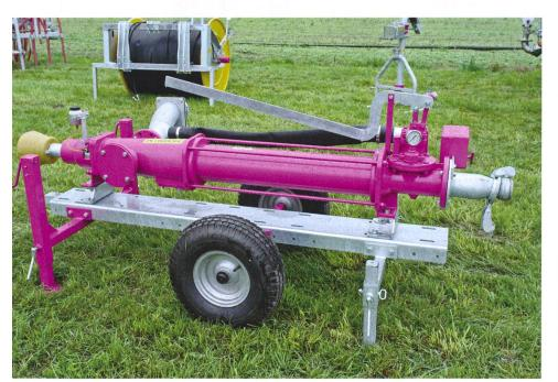
Les pompes volumétriques, plus précisément les pompes à pistons rotatifs ou à vis, sont utilisées pour tout travail avec des liquides fins, « plus épais » ou s'écoulant lentement. Dans l'agriculture, cela se matérialise dans les domaines de l'alimentation, des substrats (installations de biogaz) et du lisier.
